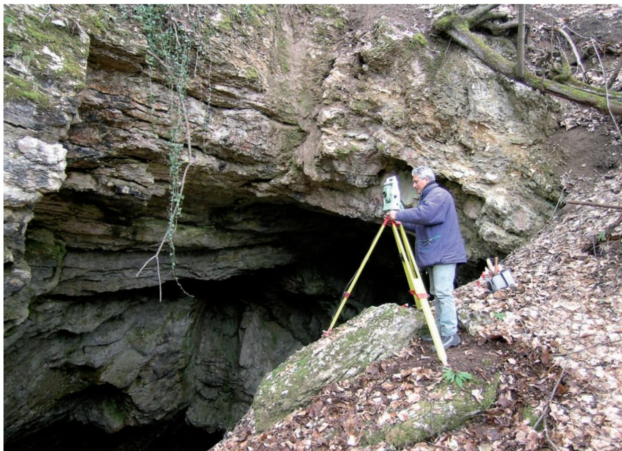
fig. 15 operazioni di rilievo con stazione totale al Tanone Piccolo della Gacciolina
