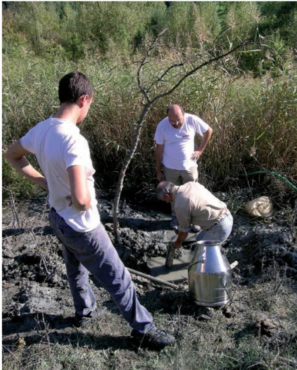
fig. 11 installazione strumenti a Montelazzo; si noti il cilindro di alloggiamento del diver e, a lato, la campana di protezione superiore
