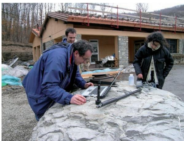
fig. 14 acquisizione su PC portatile dei dati del diver di Poiano
