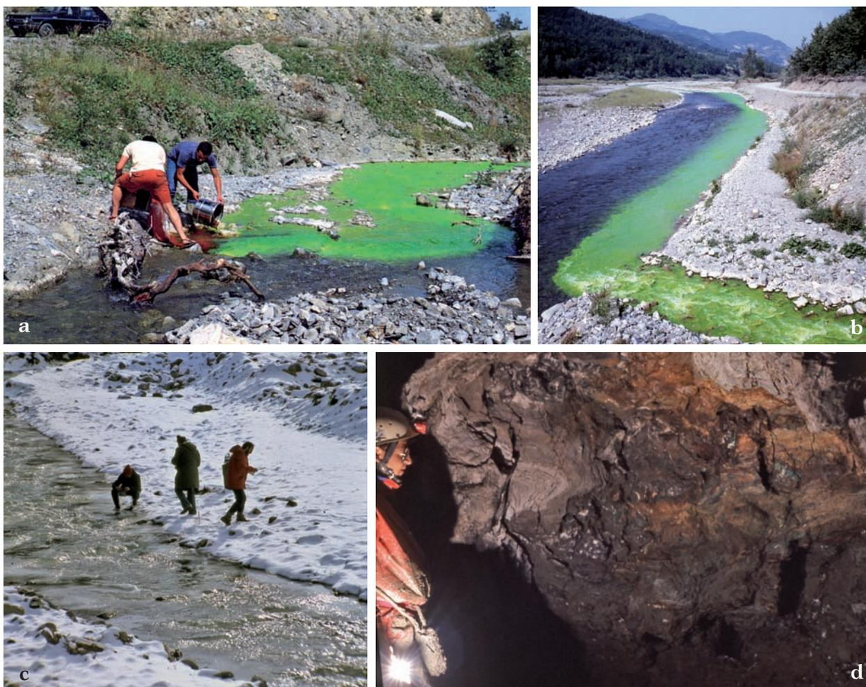
fig. 4 . a) 24 luglio 1984, immissione di fluoresceina sodica nel torrente Lucola; b) effetti della colorazione del torrente Lucola alla confluenza nel Secchia; c) 12 gennaio 1984, prelievo e analisi chimico-fisiche di campagna in acque superficiali; d) risorgente di Monte Rosso, incrostazioni di Devillina e Brochantite.
