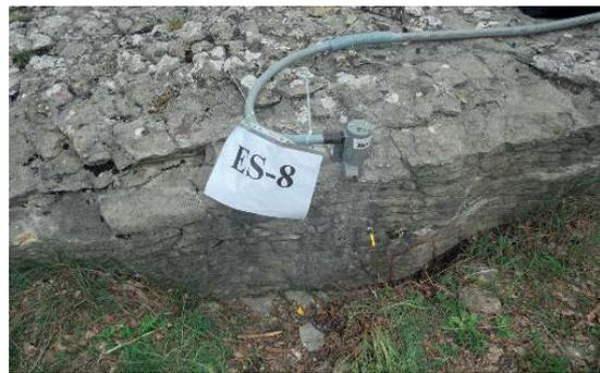
Fig. 24 - Estensimetro a filo. L'estensimetro a filo misura l'apertura della frattura attraverso un filo in acciaio in tensione. L'affidabilità è discreta, relativamente ingombrante come strumento necessaria, per la presenza di fili, di un'adeguata protezione
