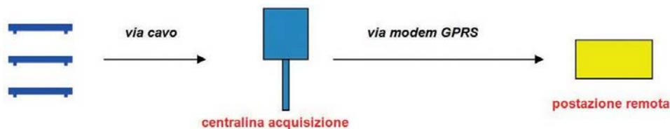
Fig. 30 - Schema di funzionamento del sistema di monitoraggio.
