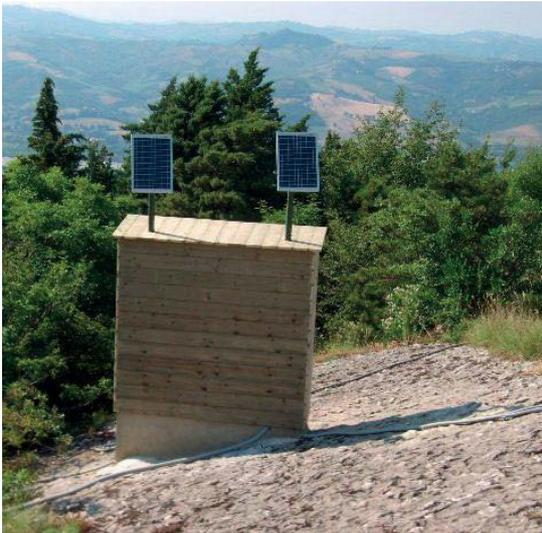
Fig. 26 - Centraline di acquisizione dati con relativi pannelli solari per l'alimentazione. Le centraline (non visibili) sono state opportunamente dotate di struttura protettiva.
