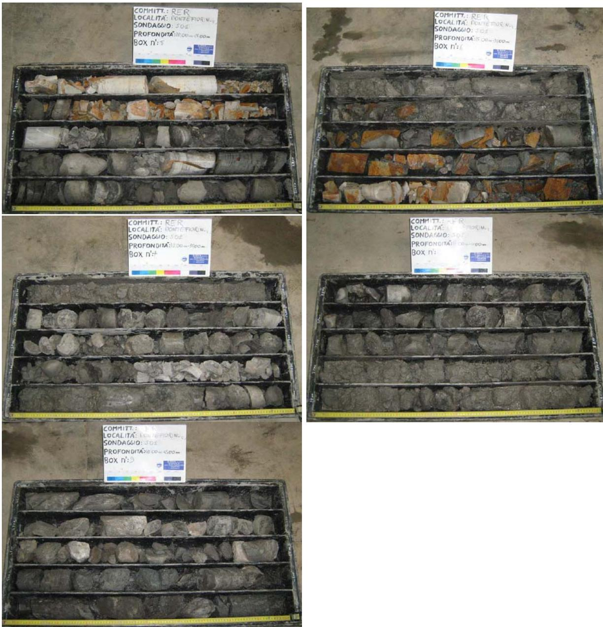
**Figura 45** – Fotografie delle casse catalogatrici relative al sondaggio d’archivio “SI4”. La freccia gialla indica l’ipotizzato inizio del substrato roccioso alterato; la freccia rossa indica l’ipotizzato inizio del substrato roccioso.
