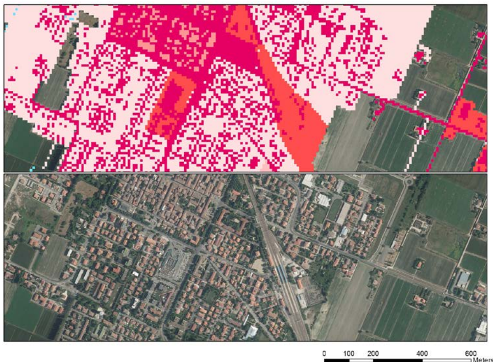
Figura 2. Esempio di come i diversi manufatti siano rappresentati nella Carta delle superfici impermeabilizzate. TONI di colore più chiari corrispondono aree a basso grado di impermeabilizzazione, l’inscurirsi dei toni indica una maggiore impermeabilizzazione.
