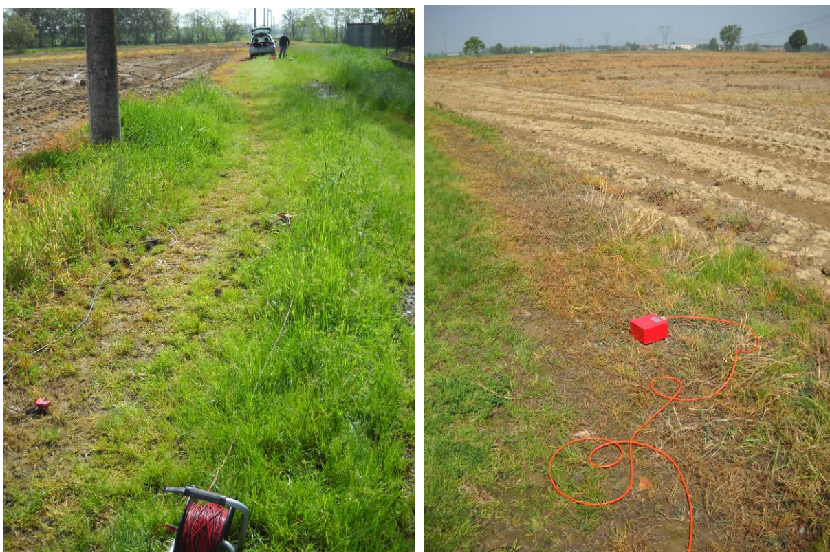
Figura 3. Stendimento sismico (a sinistra) e apparecchiatura per l'acquisizione HVSR (destra).
