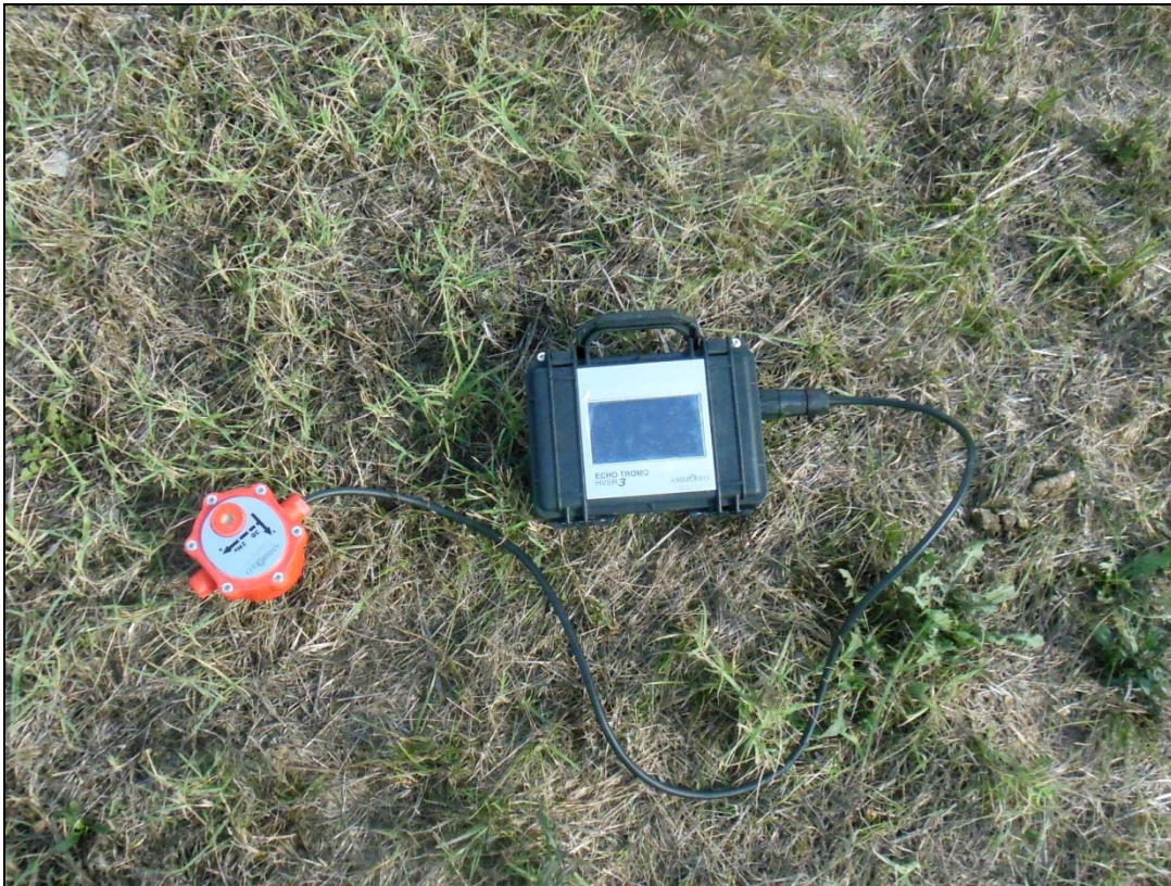
Figura 14: Tromometro digitale: centralina e geofono a tre componenti.
