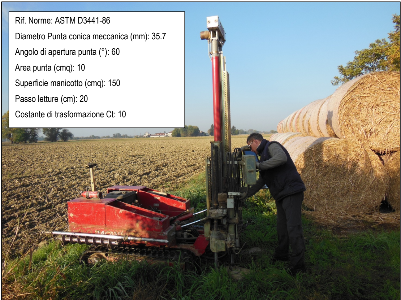
Figura 16: Penetrometro Pagani Tg 63/200 e caratteristiche tecniche.
