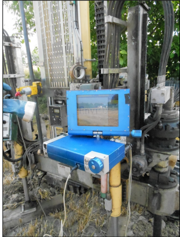
Figura 17-18: Penetrometro Pagani utilizzato per le prove penetrometriche con piezocono (CPTU) e particolare.
