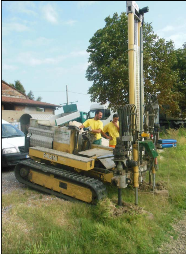
Figura 17-18: Penetrometro Pagani utilizzato per le prove penetrometriche con piezocono (CPTU) e particolare.
