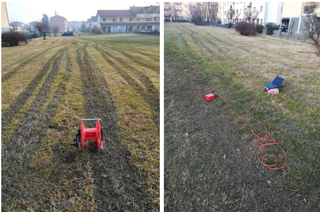
Figura 11.11 Stendimento sismico (a sinistra) e acquisizione HVSR (a destra).
