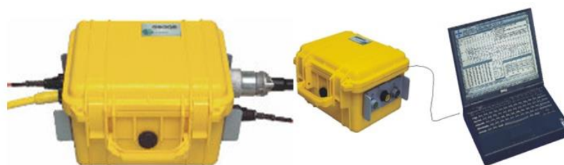
Figura 40: Sismografo "Geode" collegato al pc
