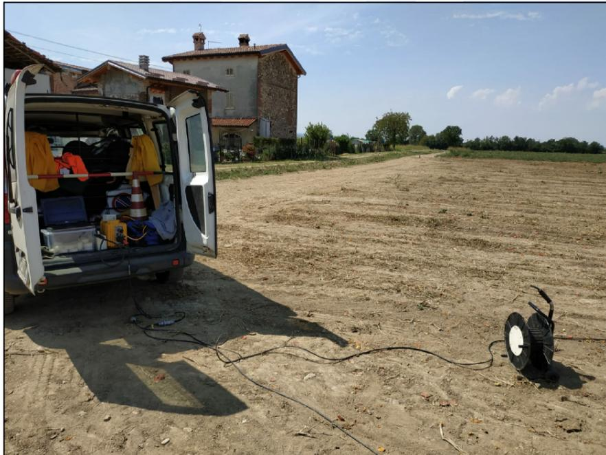
Fig. 2 - Postazione di acquisizione dati sismici.
