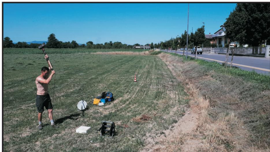
Fig. 2 - Fase di energizzazione con martello sismico
