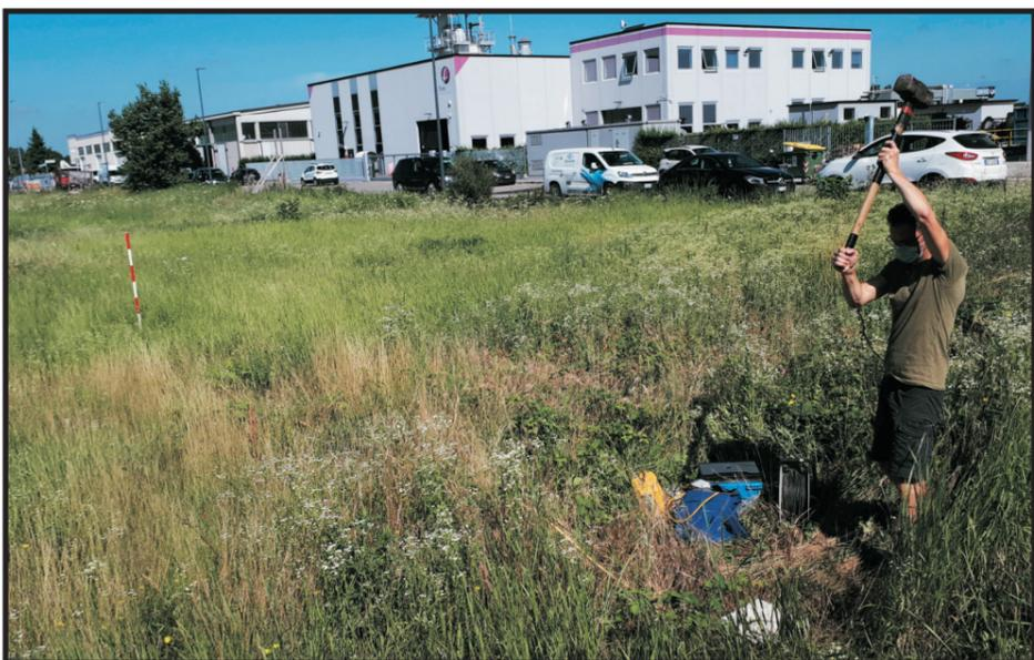
Fig. 3 - Fase di energizzazione con martello sismico
