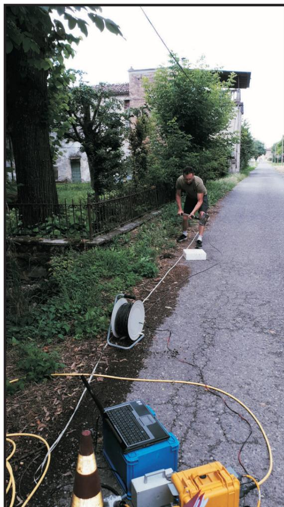
Fig. 3 - Fase di energizzazione con martello sismico
