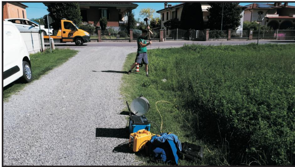
Fig. 2 - Fase di energizzazione con martello sismico
