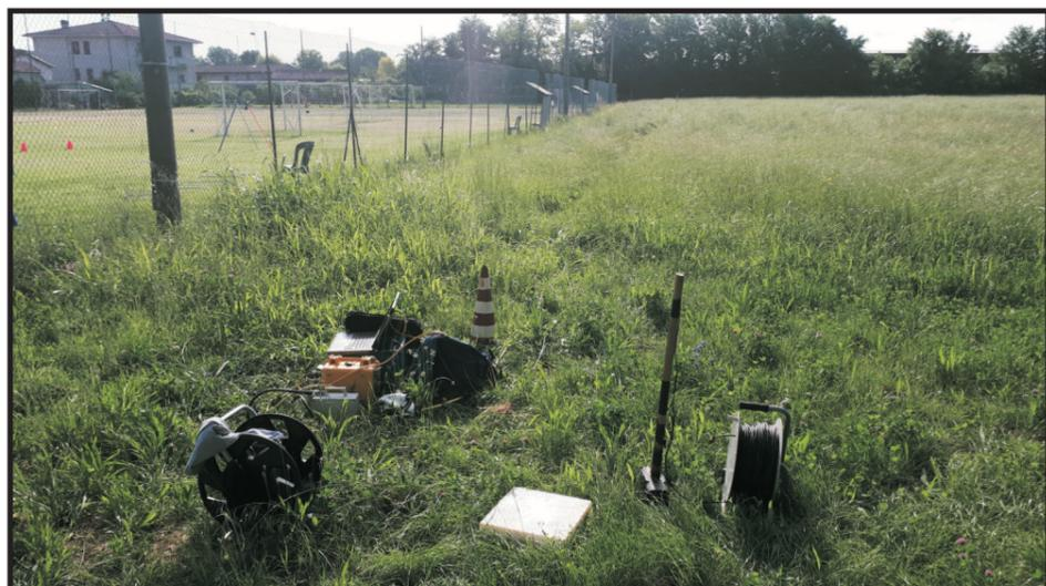
Fig. 3 - Panoramica dello stendimento sismico
