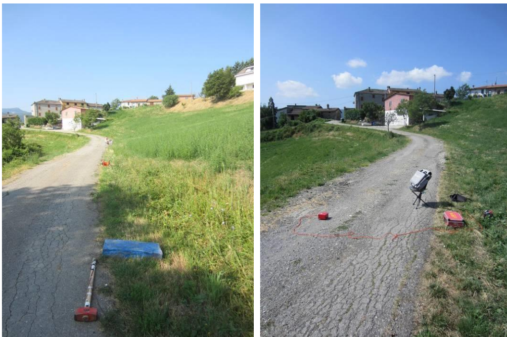
Figura 11.6. Stendimento sismico (a sinistra) e acquisizione HVSR (a destra).
