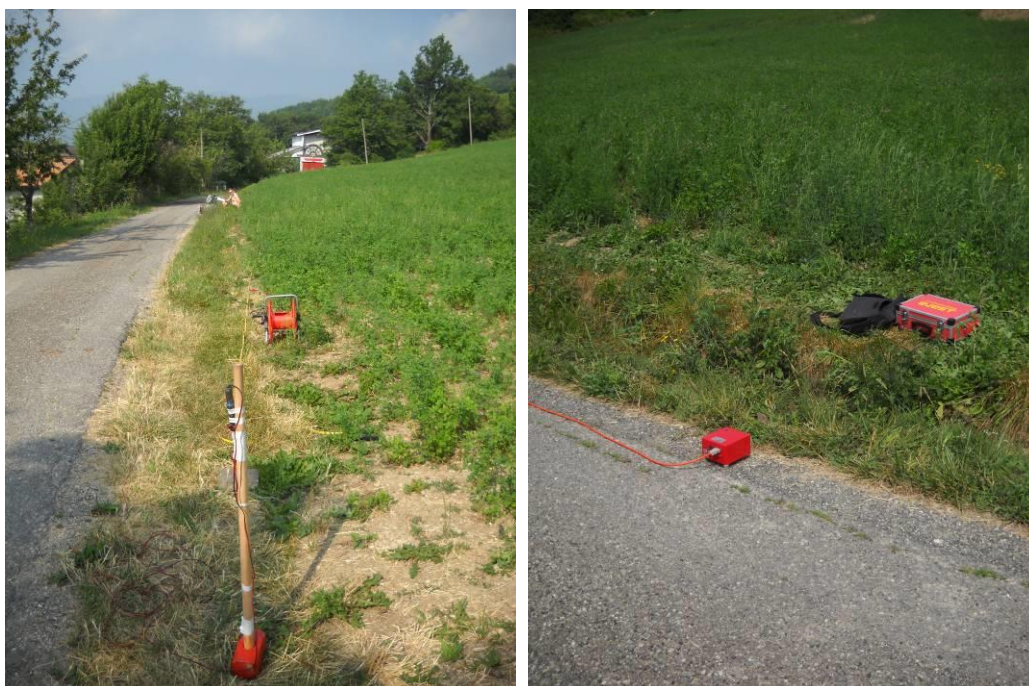
Figura 11.1. Stendimento sismico (a sinistra) e acquisizione HVSr (a destra).
