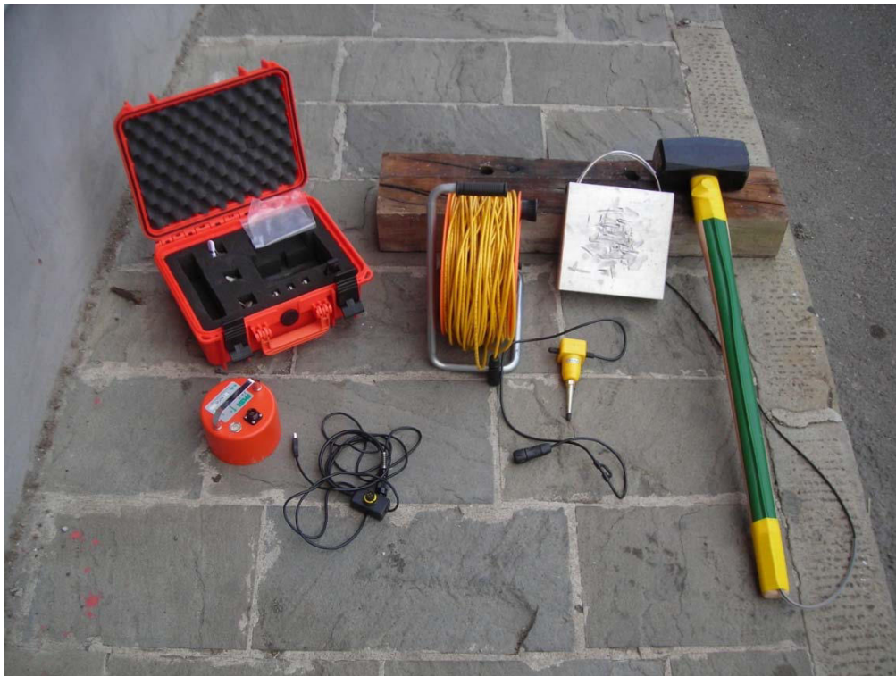
Figura A. 2 - Versione "GEMINI MASW" impiegata per la prospezione sismica attiva: lo stendimento prevede il collegamento della strumentazione procedendo da sinistra verso destra. In aggiunta va inserito il PC come per una normale acquisizione HVSR.
