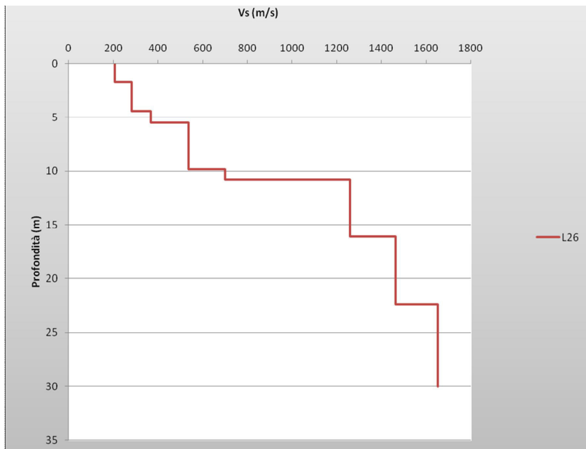
Figura 21: Profili di Vs relativi ai siti indagati all'interno dell'area di pertinenza della frazione di Ronchi
