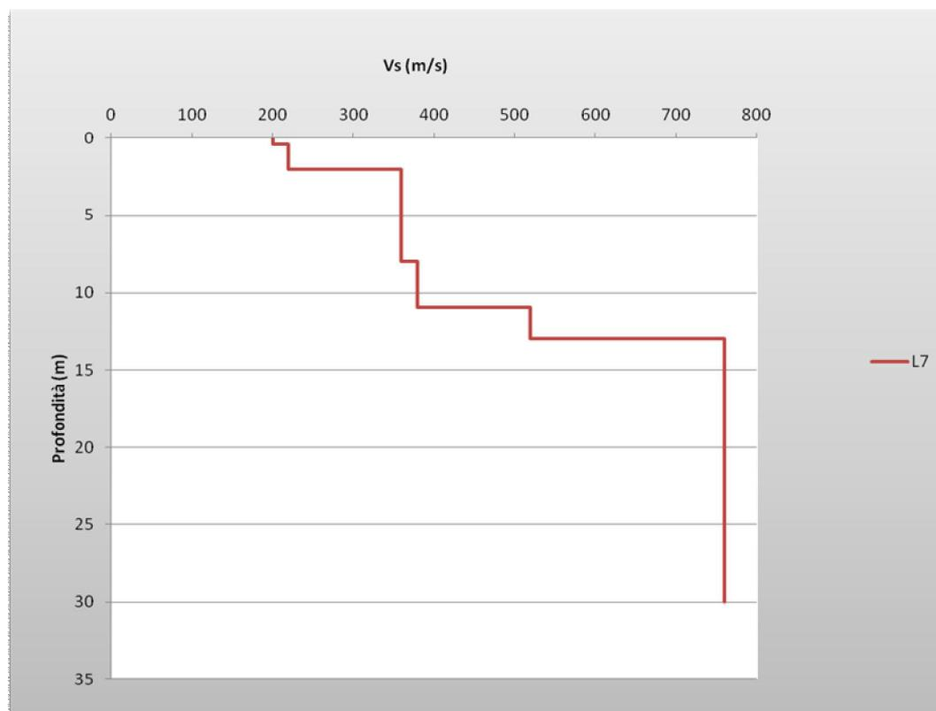
Figura 14: Profili di Vs relativi ai siti indagati all'interno dell'area di pertinenza della frazione di Praticchia
