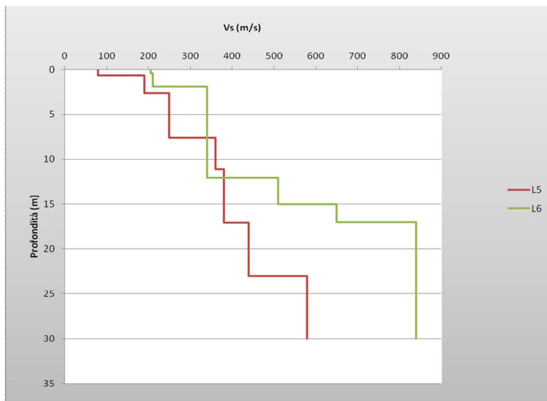
Figura 13: Profili di Vs relativi ai siti indagati all'interno dell'area di pertinenza della frazione di Cicogni
