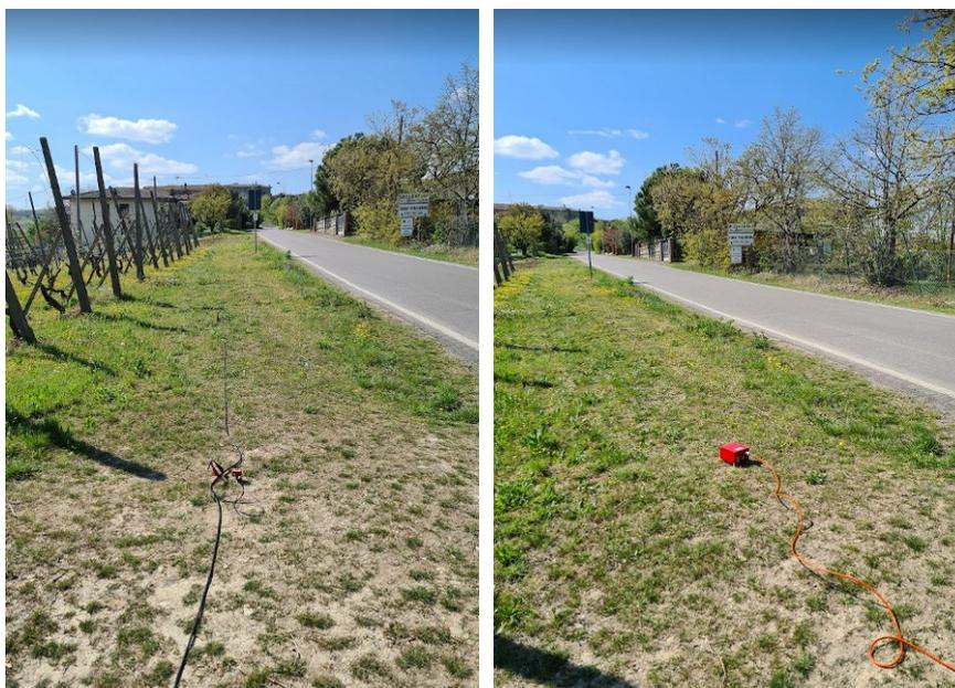
Figura 10.16. Stendimento sismico (a sinistra) e acquisizione HVSr (a destra).
