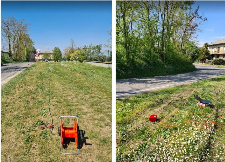
*Figura 10.6. Stendimento sismico (a sinistra) e acquisizione HVSR (a destra).*
