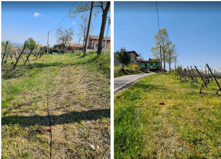
Figura 10.11. Stendimento sismico (a sinistra) e acquisizione HVSR (a destra).
