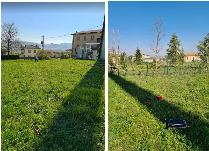
*Figura 10.1. Stendimento sismico (a sinistra) e acquisizione HVSr (a destra).*
