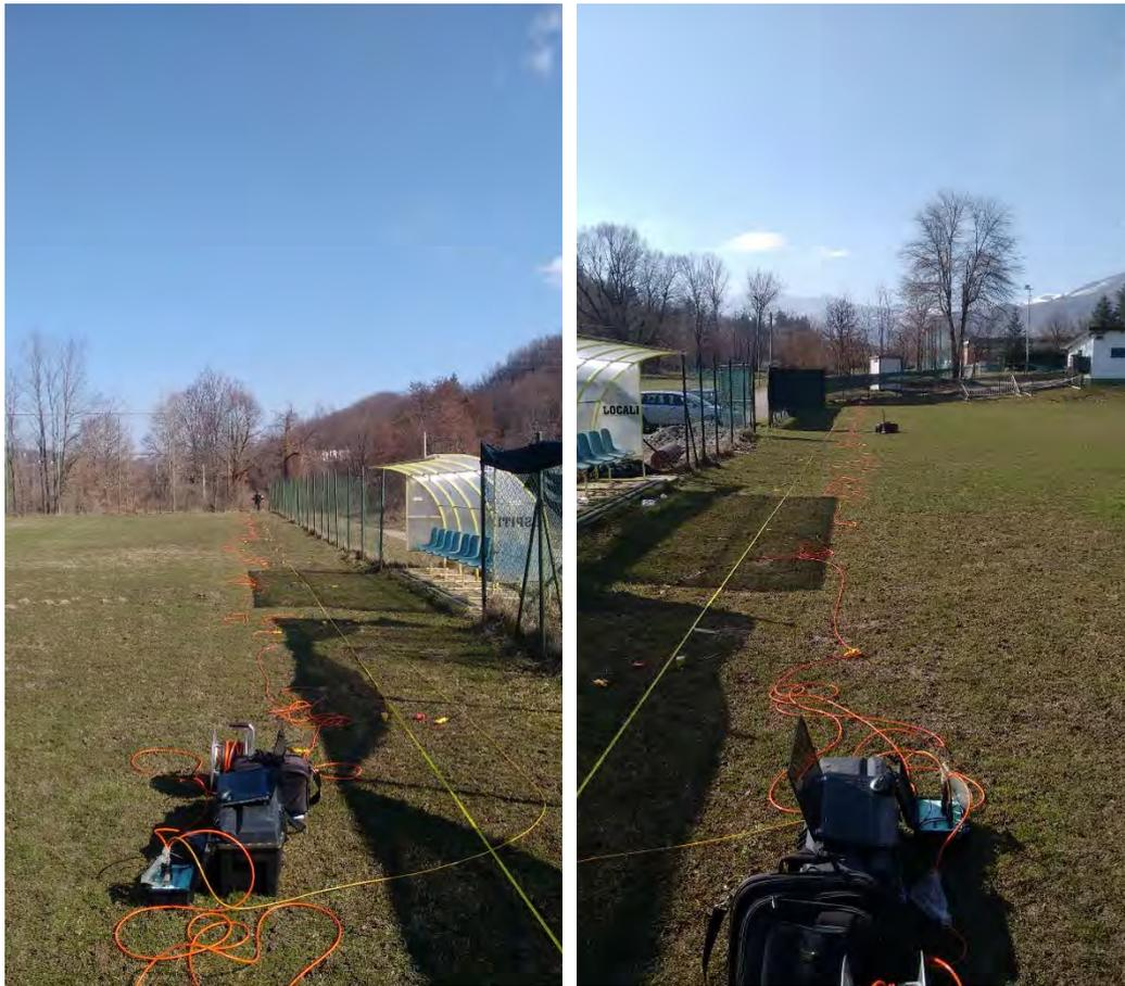
**Figura A. 1 - Stendimento sismico a rifrazione realizzato in corrispondenza dell'area di studio.**
