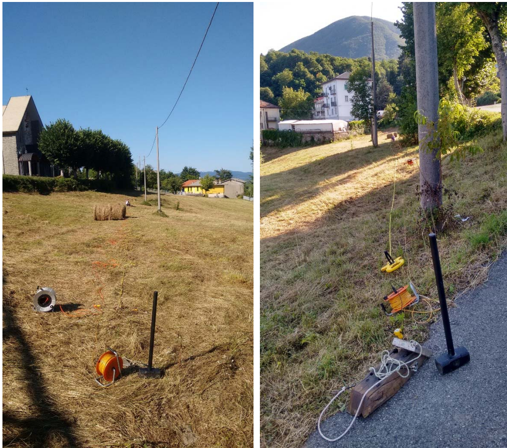
Figura A. 1 - Stendimento sismico a rifrazione realizzato in corrispondenza dell'area di studio.
