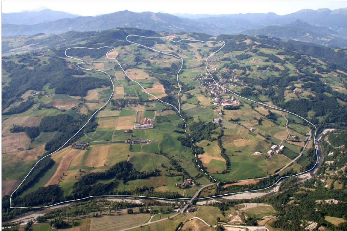
Fig. 14 - Immagine aerea della frana di Cavola nella sua interezza (destra) e della coalescente frana di Oca (sinistra). Da Relazione geologica del Progetto esecutivo dei Lavori di consolidamento e messa in sicurezza dell'abitato di Cavola - Comune di Toano - OPCM 3950/210 – OCDPC 84/2013 e 279/2015 – DGR 1480/2017.
