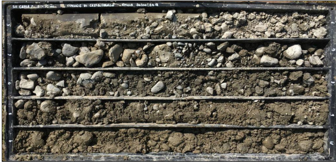
Cassetta 2: da 5,00 a 10,00 m da p.c.
