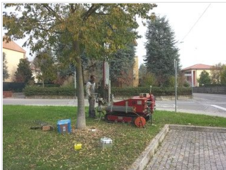
Foto 4.2 - Prova CPTU eseguita nella frazione San Donino con associata una registrazione sismica HVSR
