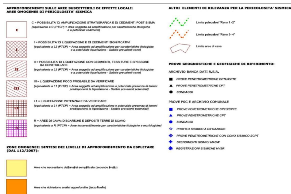
Figura 2.9 – Stralcio “Tavola 1 – Pericolosità Sismica – Tavola comunale delle aree suscettibili di effetti locali”, elaborata per il PSC di Argelato (scala 1:5.000)
