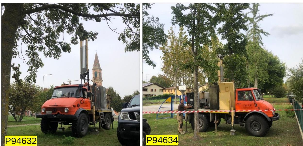
Foto 4.1 – Coni Sismici eseguiti rispettivamente nel Capoluogo (P94632) e nella frazione Passo Segni (P94634)
