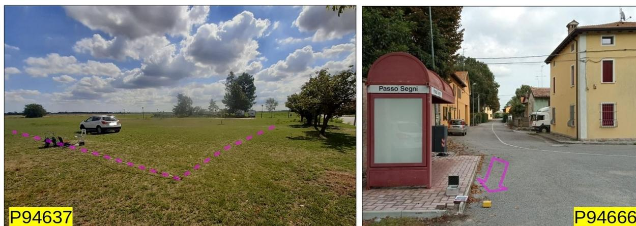
Foto 4.3 – Stendimento ESAC\_SPAC eseguito a San Gabriele e registrazione HVSR effettuata a Passo Segni
