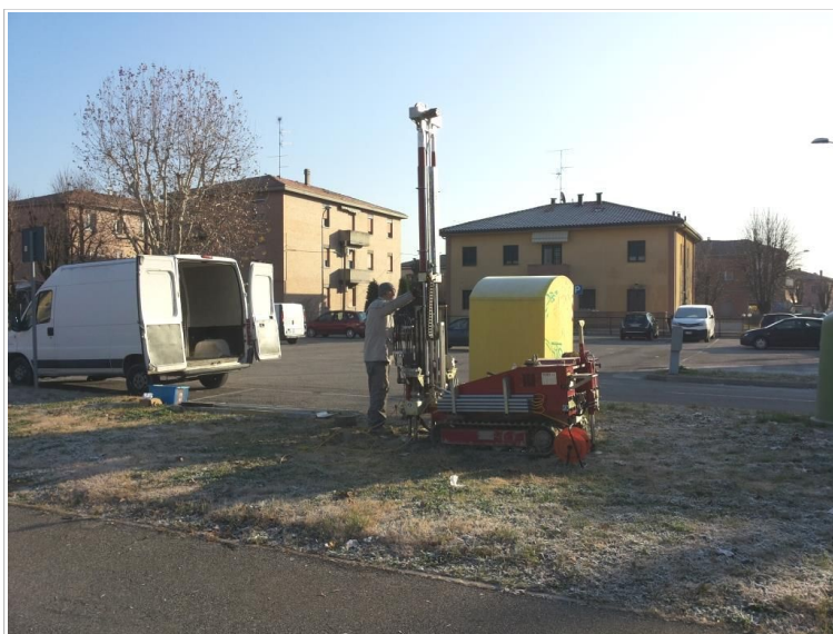
Foto 4.2 - Prova CPTU eseguita nella frazione San Marino con associata una registrazione sismica HVSR
