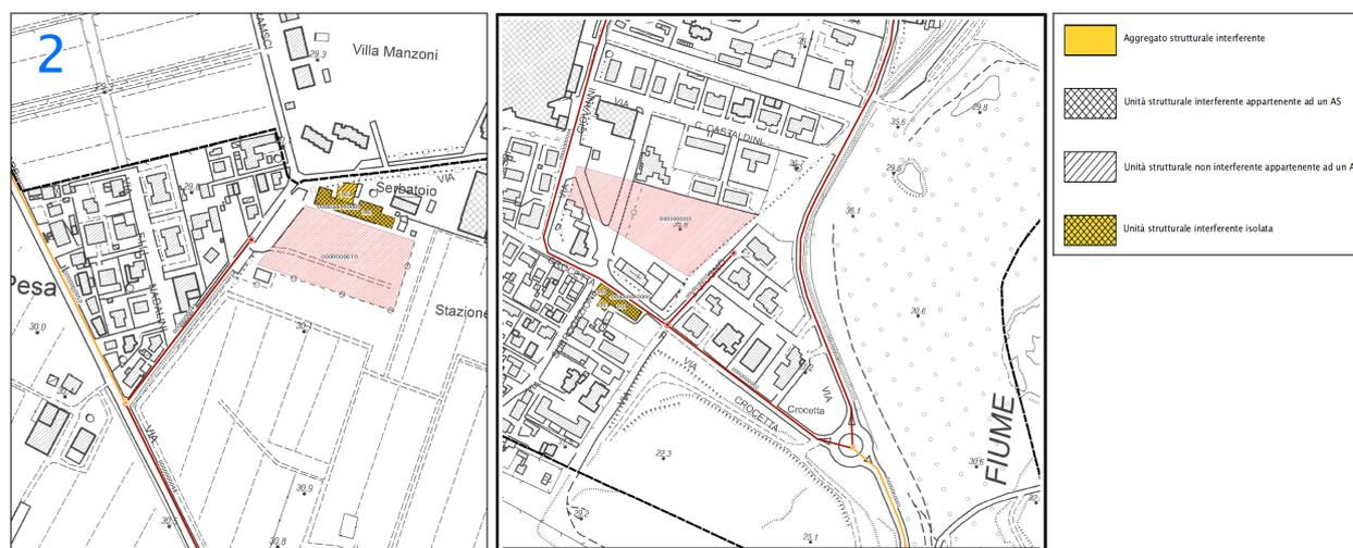
Figura 4.1 – Stralcio della cartografia di CLE (Tavola B, scala 1:2.000) con evidenziate alcune unità e aggregati strutturali interferenti con la viabilità di connessione e/o con le aree di emergenza.
