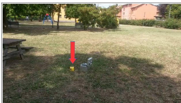
Foto 4.4 – Prova HVSR eseguita a Castel Campeggi (acquisizione di 60'). La freccia rossa indica lo strumento in fase di registrazione
