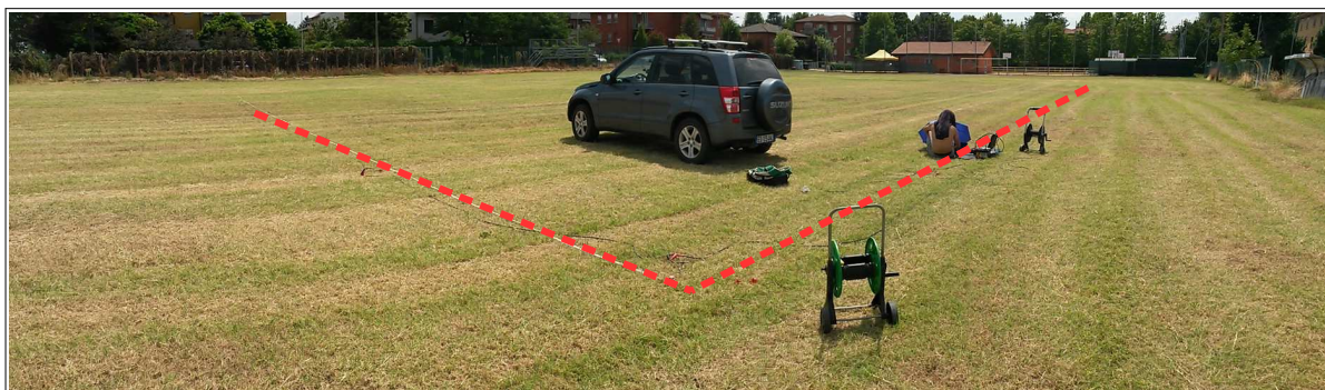
Foto 4.3 – Prova ESAC eseguita nella frazione Longara (campo sportivo)
