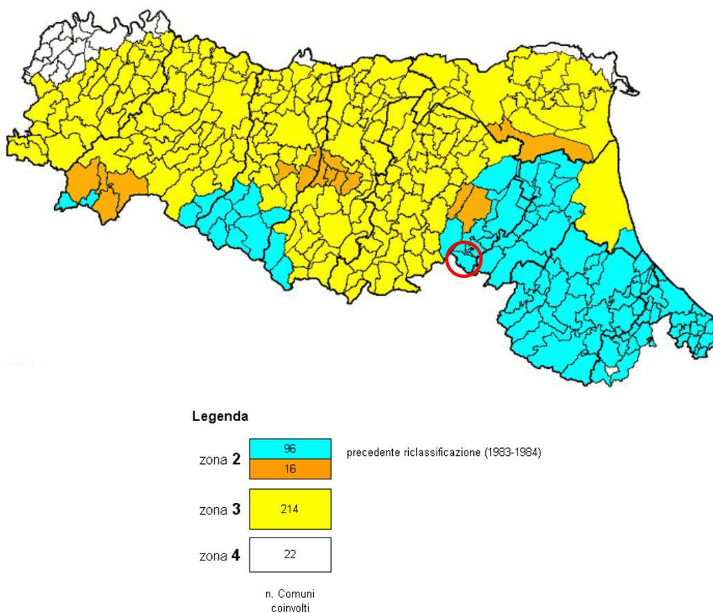
Figura 2 - Riclassificazione sismica dell'Emilia-Romagna, Ordinanza del PCM n. 3274/2003 (Allegato 1, punto 3 "prima applicazione" (da sito web Regione Emilia-Romagna: <http://ambiente.regione.emilia-romagna.it/geologia/temi/sismica/la-classificazione-sismica>)). Il cerchio in rosso individua il Comune di Castel del Rio.
