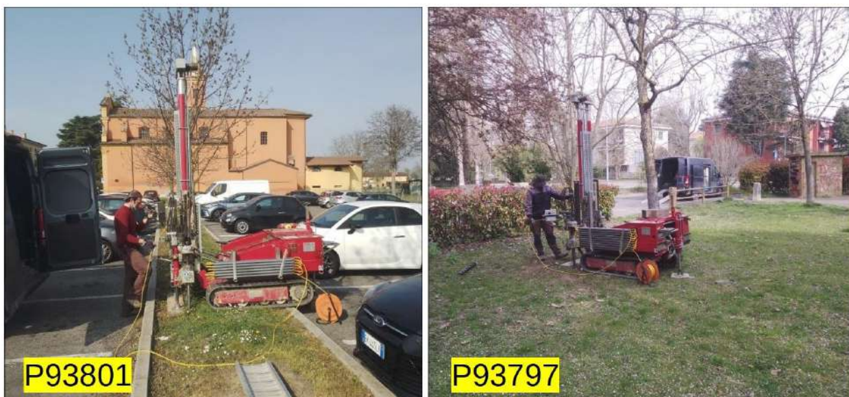
Foto 4.1 - Prove CPTU eseguite a Cadriano (P93801) e a Quarto Inferiore (P93797)
