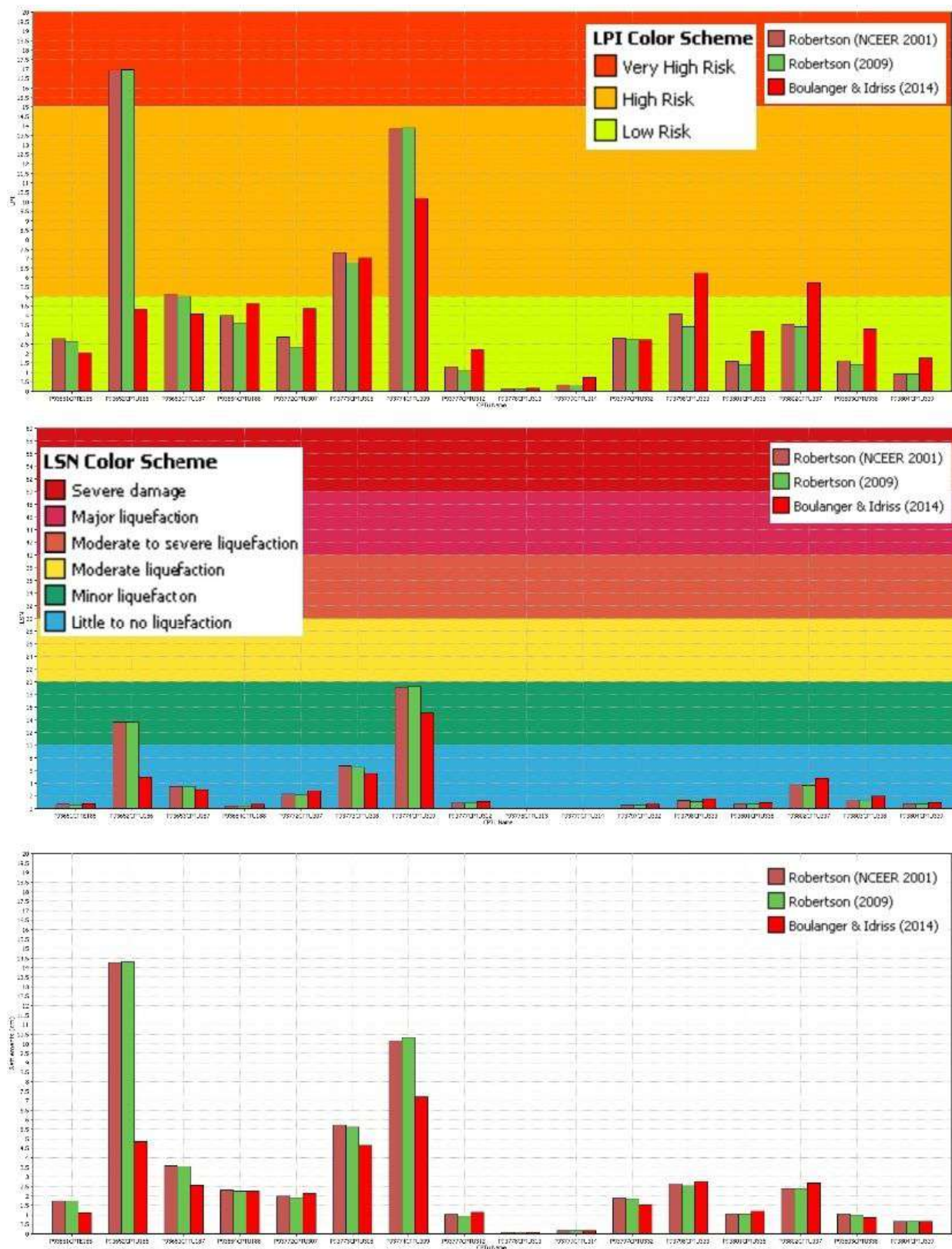
Figura 7.10 – Confronto dei valori di LPI, LSN e cedimento post sisma cumulativi ricavati con tre differenti procedure di calcolo dell'FS (NCEER 2001; P.K. Robertson 2009; Boulanger & Idriss 2014). Punti di controllo relativi alle frazioni
