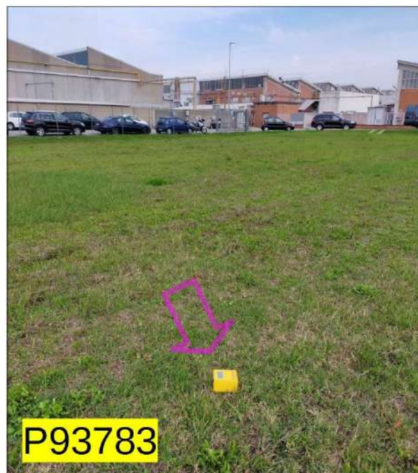
Foto 4.3 – Registrazione HVSR effettuata presso Cadriano (P93783HVSR)
