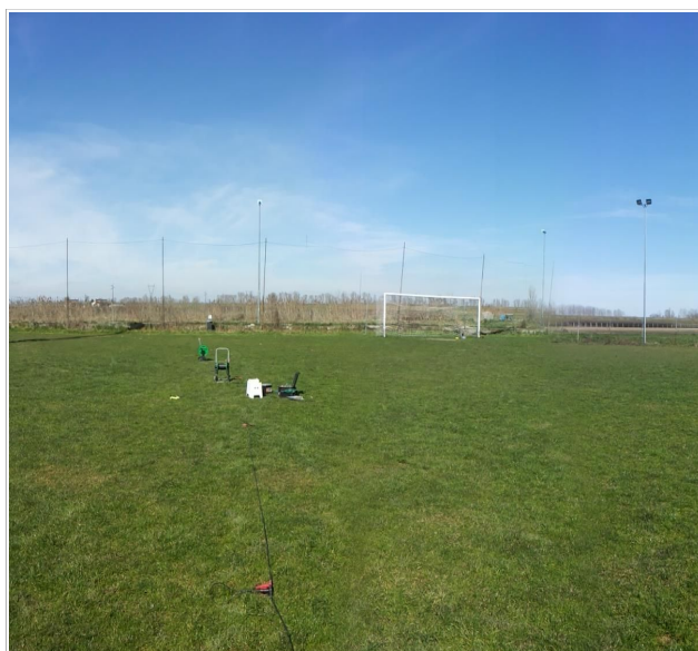
Foto 4.3 - Prova ESAC_SPAC eseguita nel Capoluogo
