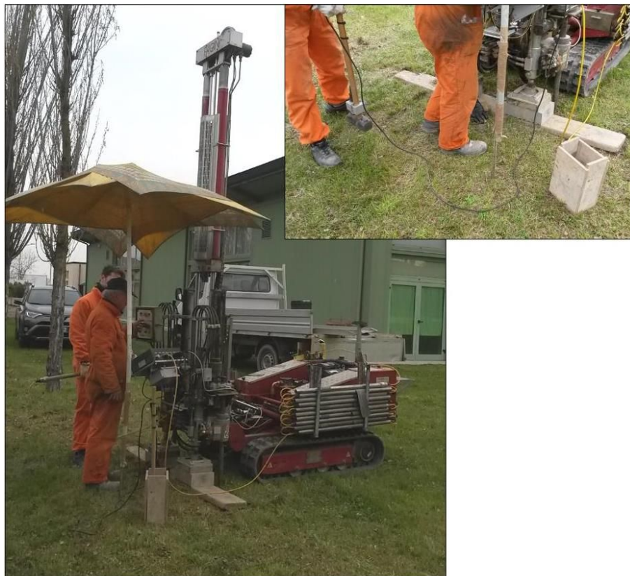
Foto 4.2 - Prova CPTU e "Cono Sismico" eseguita a Malalbergo
