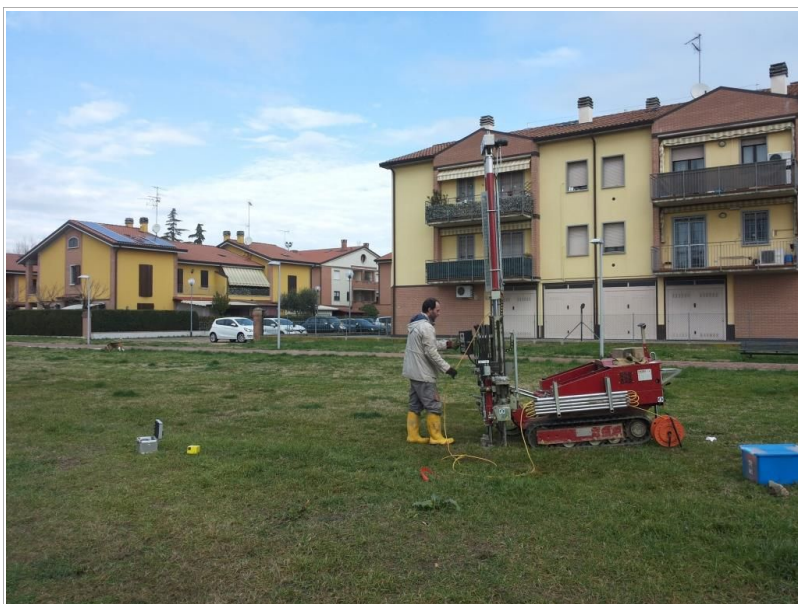
Foto 4.1 – Prova CPTU eseguita nel Altedo con associata una registrazione sismica HVSR
