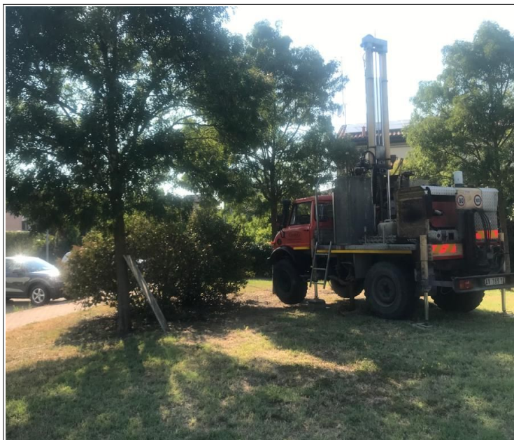
Foto 4.2 - Prova SCPTU (sigla: P94635) eseguita nel Capoluogo (area verde via della Costituzione)
