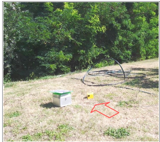
Foto 4.5 – Registrazione HVSr effettuata nella frazione Capo d'Argine (P94631 HVSr)
