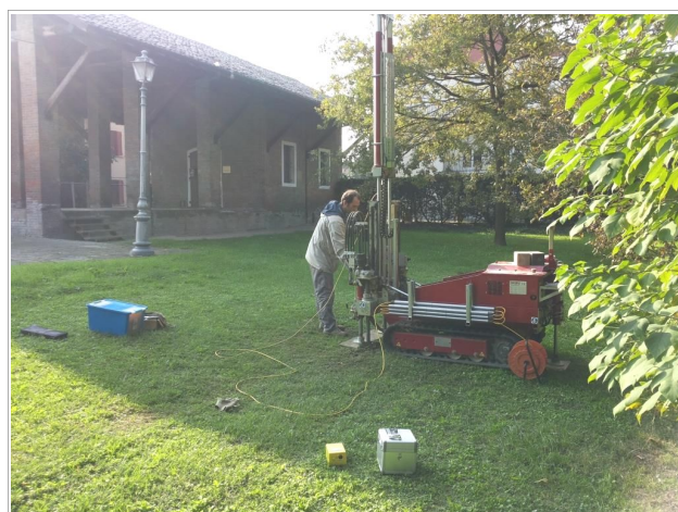
Foto 4.2 – Prova CPTU eseguita nel Capoluogo in via 25 Aprile con associata una registrazione sismica HVSR
