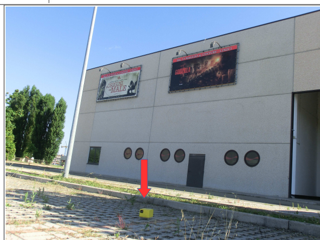
Foto 4.5 - Prova HVSR eseguita nel Capoluogo (in prossimità del cinematografo multisala). La freccia rossa indica lo strumento in fase di registrazione.
