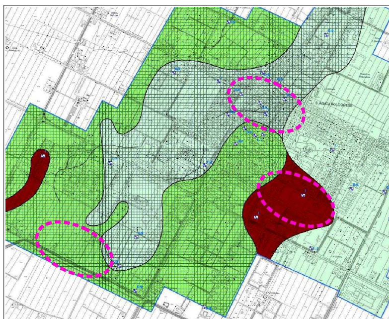
Figura 7.1 – Stralcio della “Carta delle Indagini” e localizzazione dei tre principali modelli sismostratigrafici rappresentativi del Capoluogo . La figura evidenzia le principali indagini geognostiche e geofisiche di riferimento per ciascun modello. In azzurro: le prove eseguite per gli studi di MS; in verde: prove di repertorio (principali)
