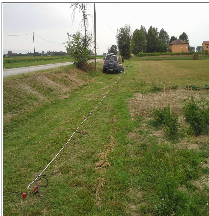
Foto 4.3 – Prova MASW/ReMi eseguita a sud del Capoluogo
