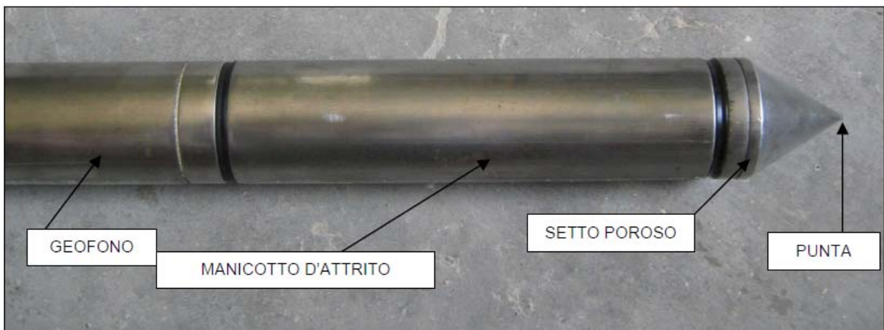
Fig. 2 - Punta del penetrometro elettrico e sismocono
