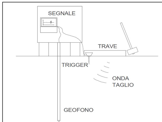
Rappresentazione grafica della prova penetrometrica con piezometro sismico
