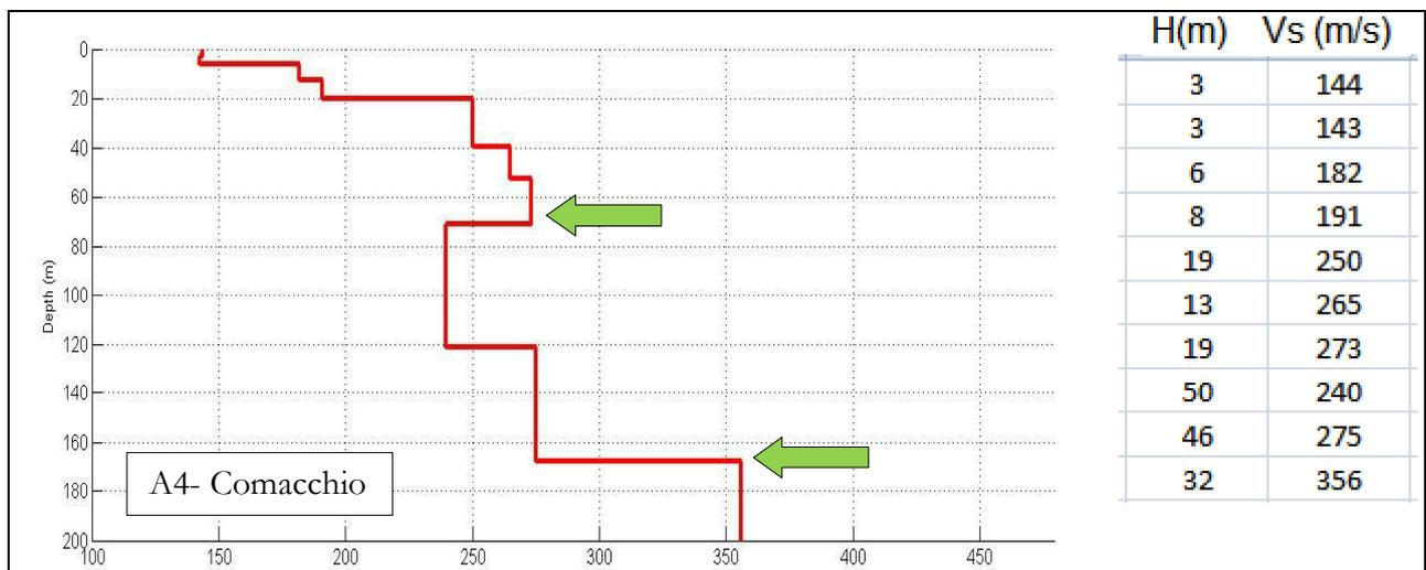
**FIGURA 8.2** - Profili di Vs profondi, con evidenziato il primo contrasto di impedenza che può essere all'origine del modo di vibrare con frequenze  $F_0$  pari ad 1,0 Hz e del secondo contrasto di impedenza che può essere all'origine del modo di vibrare con frequenze  $F_0 < 0,4$  Hz
