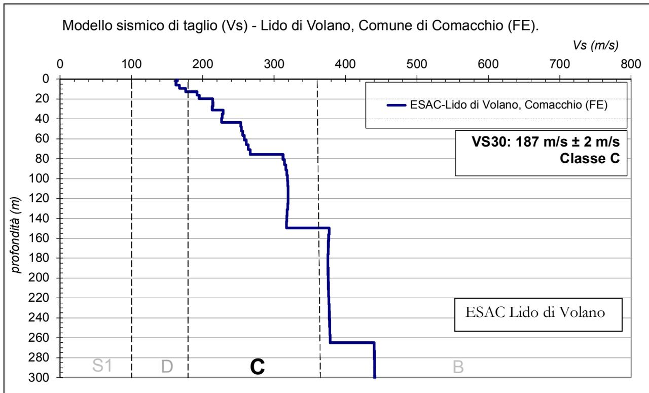
*Il profilo verticale VS ottenuto per l'area indagata dal profilo sismico. In base al modello sismico è stata determinata la VS30 che risulta pari a 187 m/s ± 2 m/s.*
