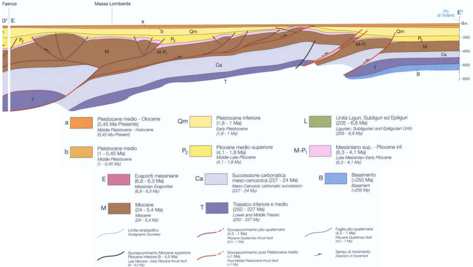
**FIGURA 2-6** – Sezione geologica strutturale lungo la sezione E-E'
