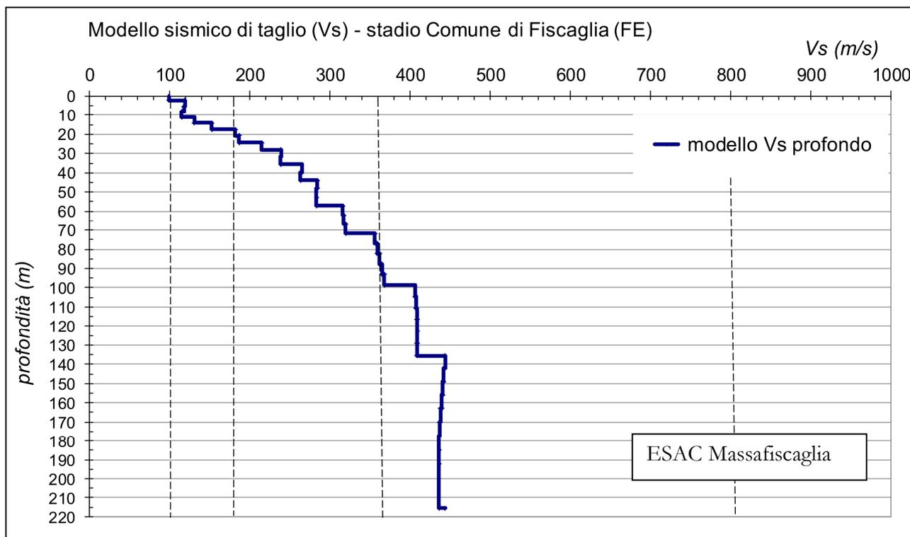
*Il profilo verticale VS ottenuto per l'area indagata dal profilo sismico. In base al modello sismico è stata determinata la VS30 che risulta pari a 146 m/s  $\pm$  4 m/s (RMS=1.5%).*
