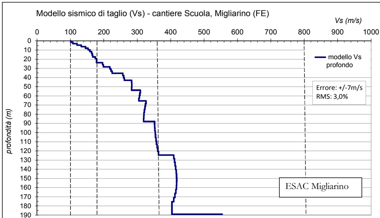
*Il profilo verticale VS ottenuto per l'area indagata dal profilo sismico. In base al modello sismico è stata determinata la VS30 che risulta pari a 156 m/s  $\pm$  7 m/s.*
