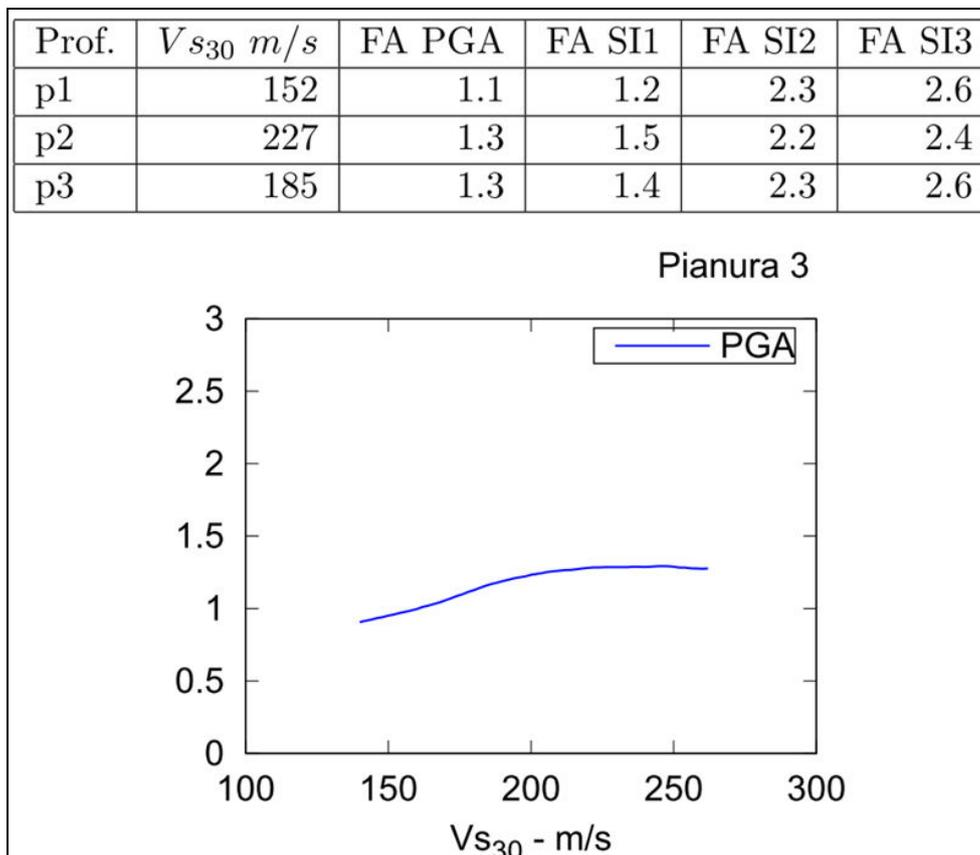
**Figura 6-3** - Per valori di  $V_{s30}$  compresi tra 152 m/sec e 185 m/sec il fattore di amplificazione sismica F.A. per la P.G.A. varia tra 1,1 e 1,3, mantenendosi intorno a 1,3 per valori di  $V_{s30}$  superiori a 185m/sec.
