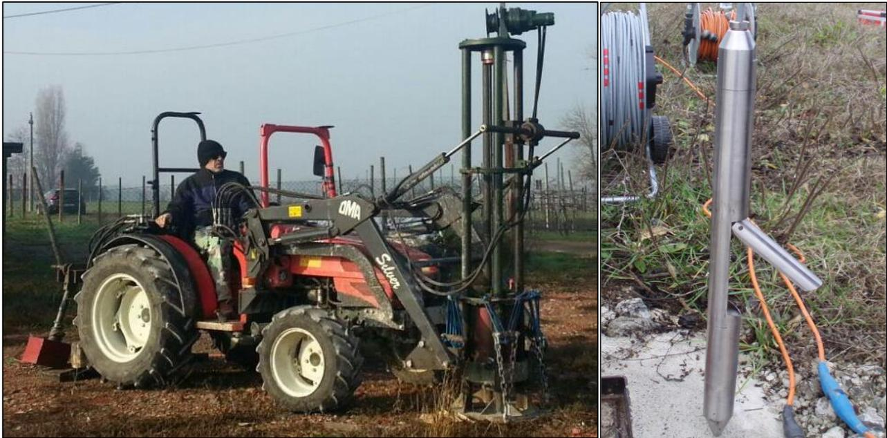
Figura 4-1 - A sinistra, macchina operatrice con funzione di sorgente delle onde sismiche. A destra, apparato di ricezione dei segnali costituito da sonda calettata contenete geofoni monoassiali da 10 Hz.
