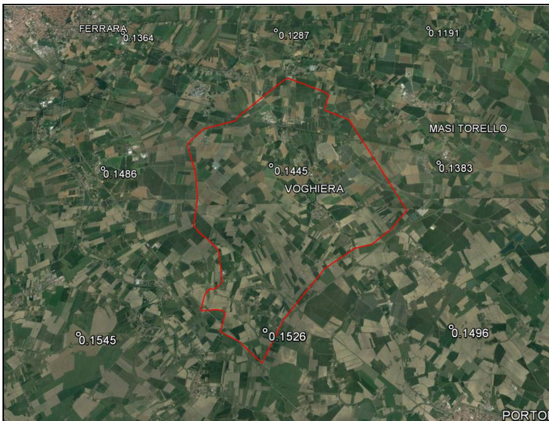
**FIGURA 6.2** - Valori di accelerazione di picco su suolo rigido secondo la DGR 2193/2015).
