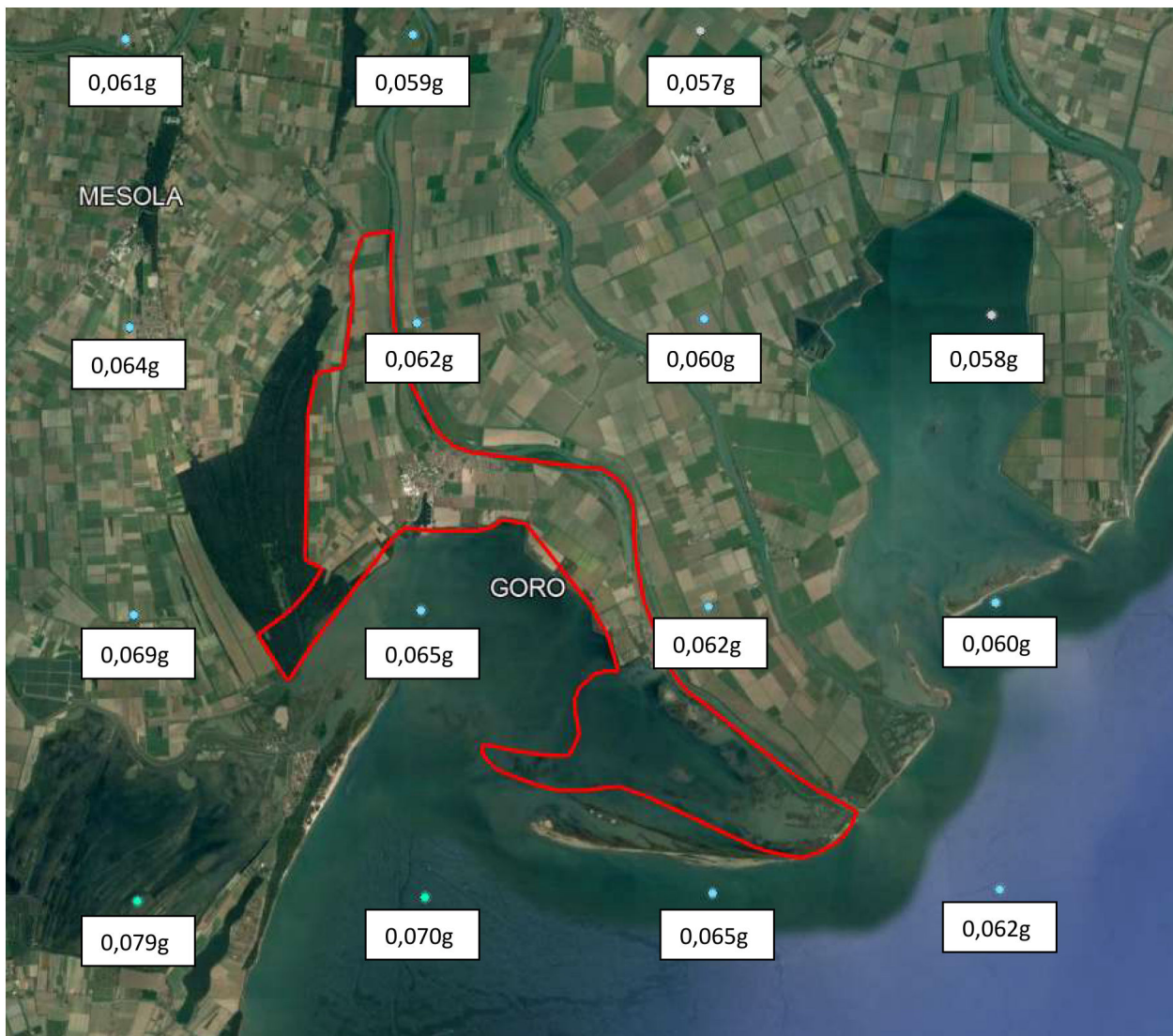
Figura 2-29 – Territorio comunale di Goro con griglia dei punti e rispettivi valori di accelerazione orizzontale massima su suolo rigido
