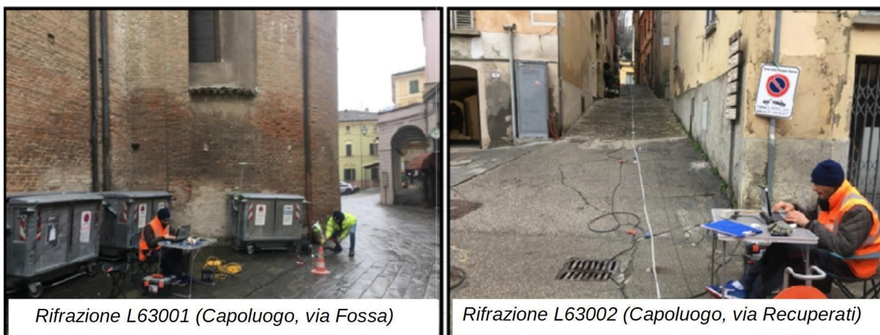
Foto 4.3 – Esecuzione degli stendimenti sismici a rifrazione nel Capoluogo.
