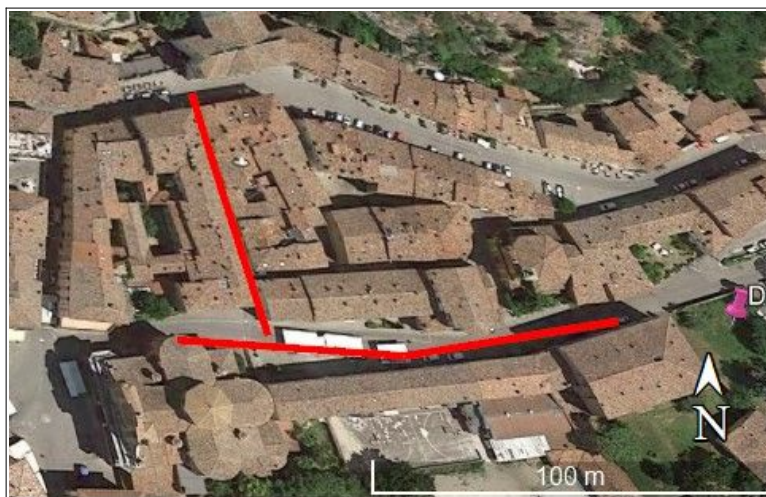
Figura 4.3 – Localizzazione degli stendimenti sismici a rifrazione realizzati nel Capoluogo (foto aerea: “Google Earth”)
