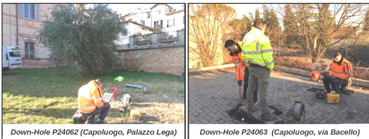
Foto 4.2 – Esecuzione delle prove sismiche in foro "Down-Hole" nel Capoluogo.
