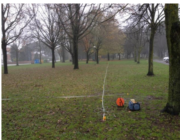
Figura 5.3– Nel pannello di sinistra, misura su Antenna Sismica ESAC . Nel pannello di destra, indagine a stazione singola HVSR.
