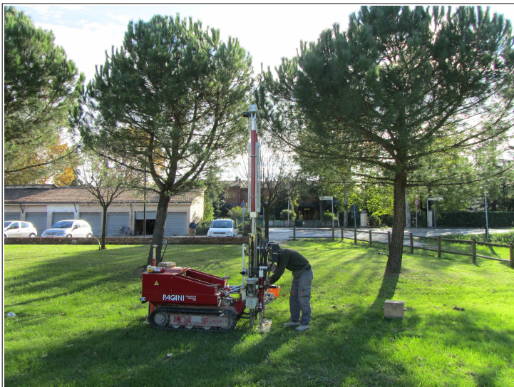
Foto 4.1 – Una delle prove CPTU eseguite nel Capoluogo.
