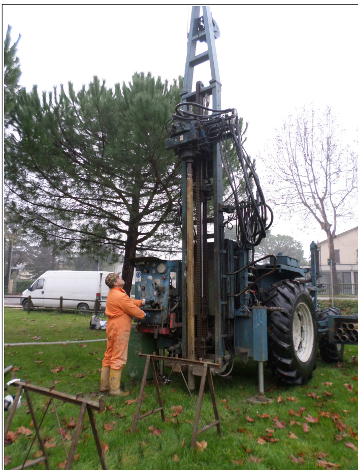
Foto 4.2 – Sondaggio a carotaggio continuo eseguito nel Capoluogo in via Fossa di Sopra.
