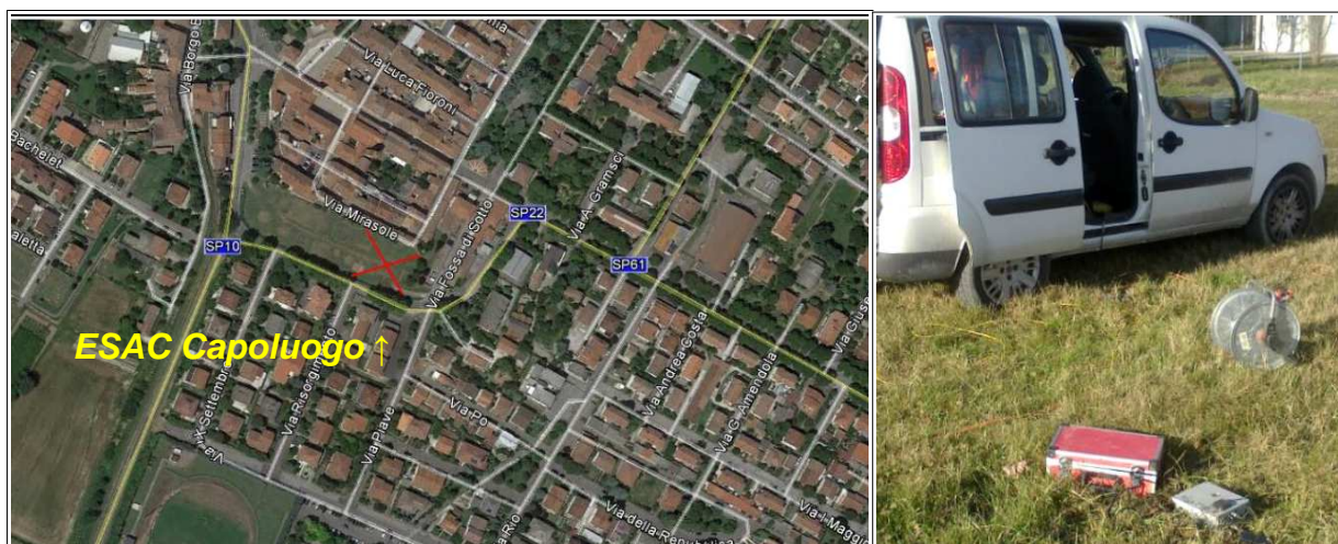
Foto 4.4 – Prova MASW/ReMi + ESAC eseguita nell'area Capoluogo. La foto riprende il lato più lungo dell'array bidimensionale disposto a "L".
