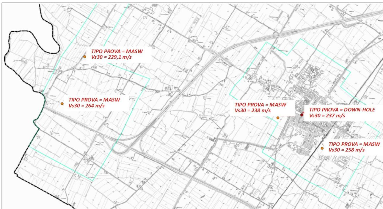
**Figura 5.13** – Localizzazione delle indagini geofisiche di Solarolo con i valori di  $V_s$  risultati riferimenti per questo lavoro.
