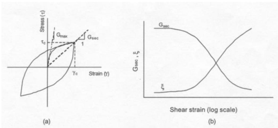
Figura n. 22 - Modello lineare equivalente:
