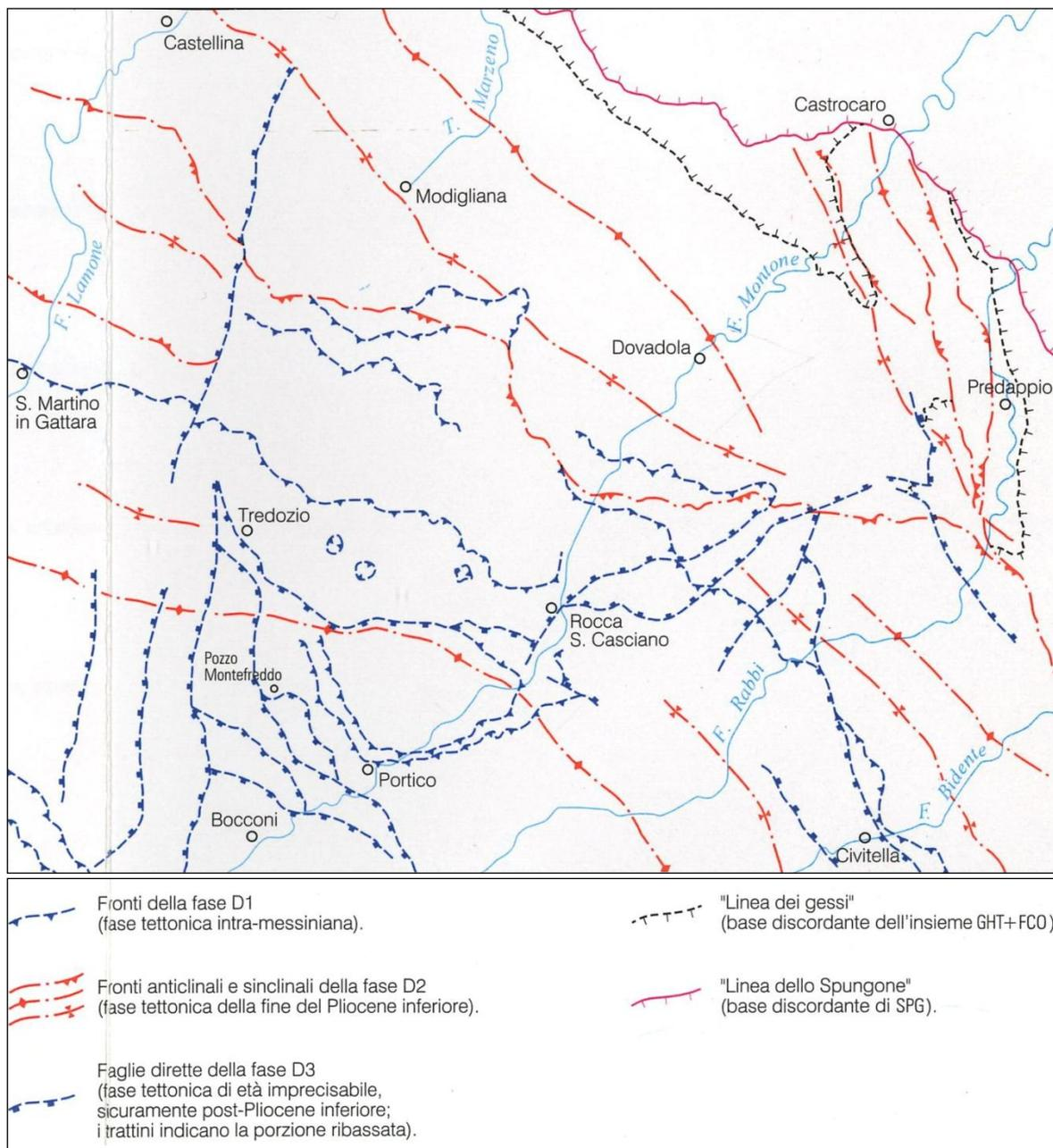
Figura n. 4 - Schema tettonico della zona ove ricade anche il territorio di Civitella di Romagna
