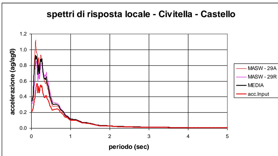
Figura n. 23 - Spettri di risposta locale. Area Castello di Civitella di Romagna (sezione 6)
