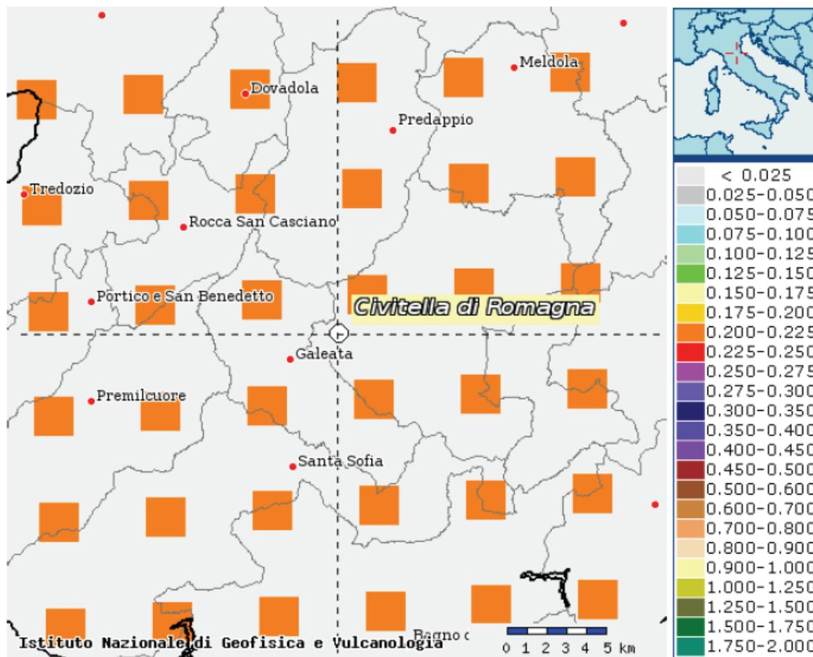
Figura n. 16 - Stralcio della Mappa di pericolosità sismica espressa in termini di  $a(g)$  per un Tempo di ritorno di 475 anni
