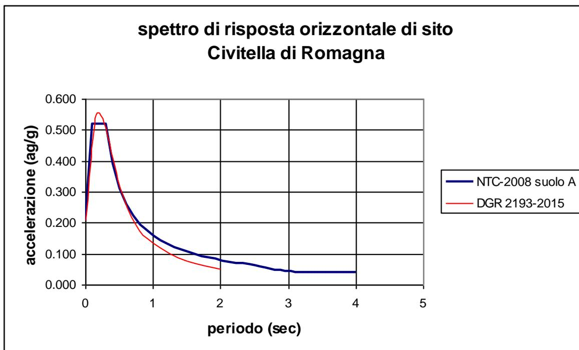
Figura n. 18 - Confronto tra spettro a probabilità uniforme e spettro di risposta elastico da NTC2008
