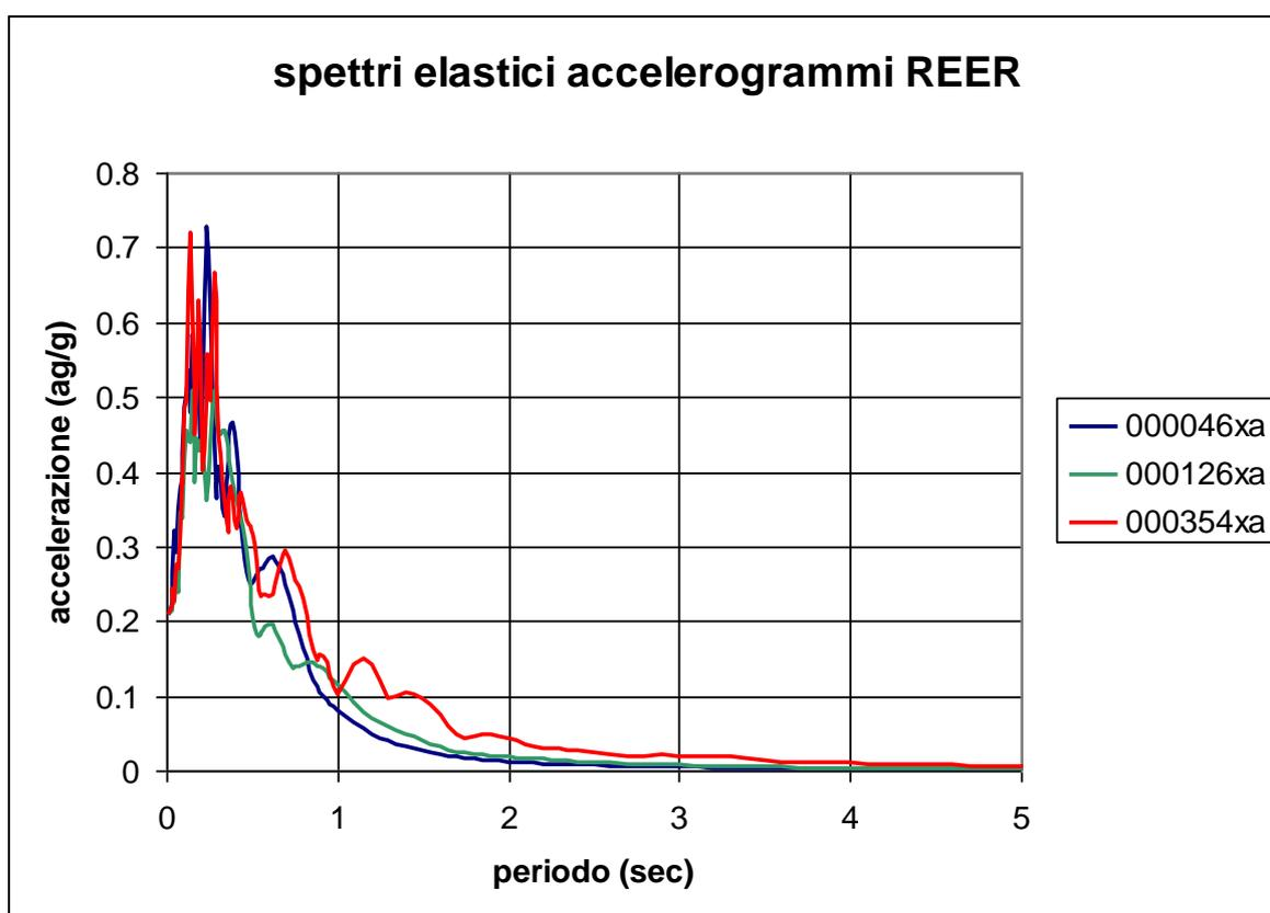
Figura n. 21 - Spettri dei segnali di input di riferimento
