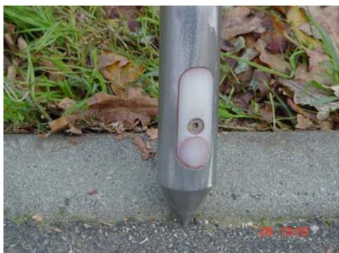
Importante notare che i ricevitori, essendo montati in appositi alloggiamenti isolati acusticamente dal resto della sonda (vedasi dettaglio nell'immagine alla pagina seguente), permettono di ricevere l'energia proveniente dal terreno sollecitato e non quella che si propaga lungo l'asta penetrometrica di infissione.
