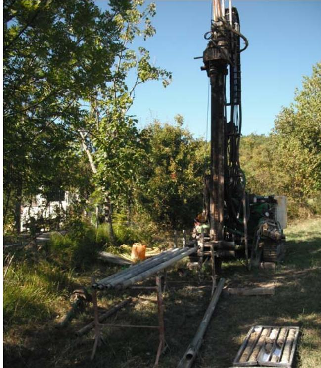
**Figura 24:** Sonda posizionata per il sondaggio geognostico in Loc. Montecoronaro
