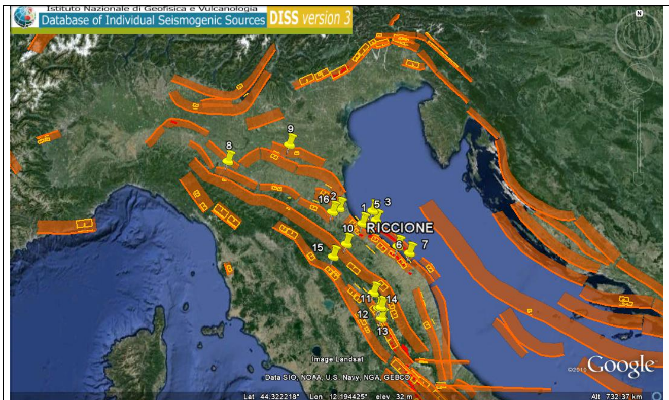
Figura 3.2–Epicentri degli eventi sismici selezionati da DBM11 in rapporto alle sorgenti sismo-genetiche individuate dal catalogo DISS (Database of Individual Seismogenic Sources) dell'Istituto Nazionale di Geofisica e Vulcanologia.
