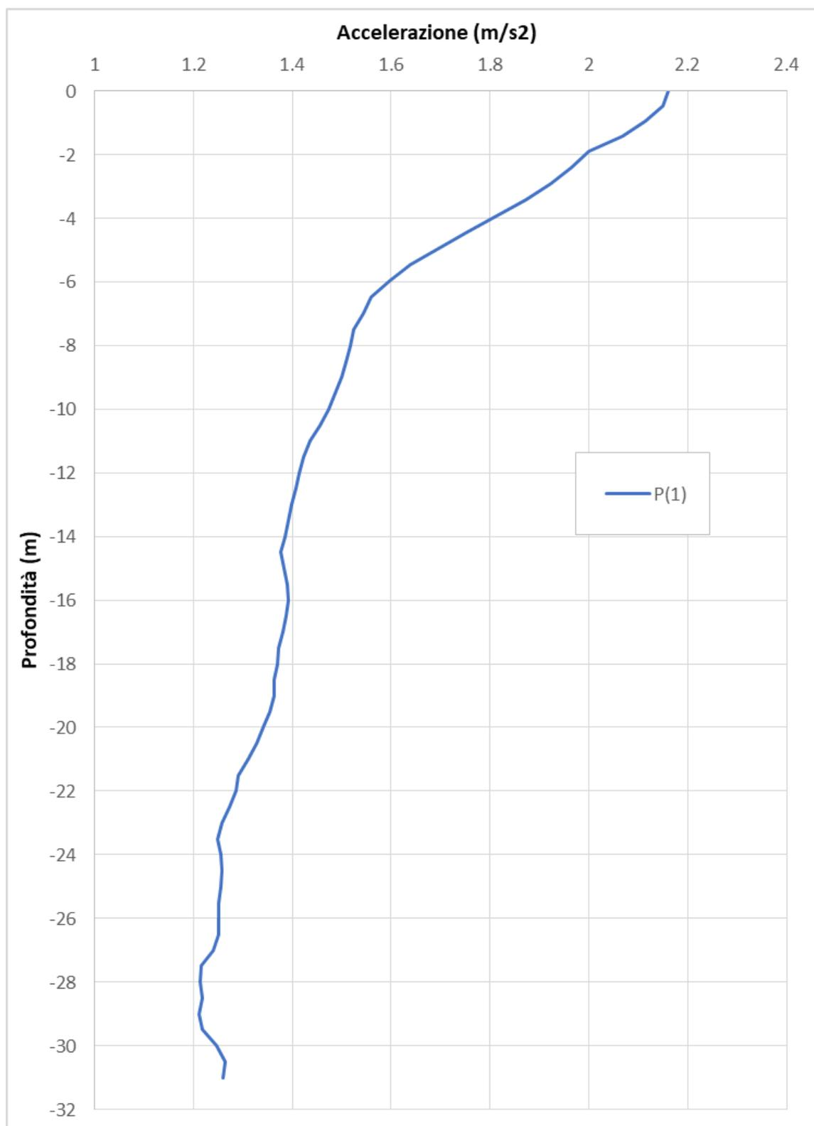
**Fig. 14 - Variazione dell'accelerazione con la profondità**
