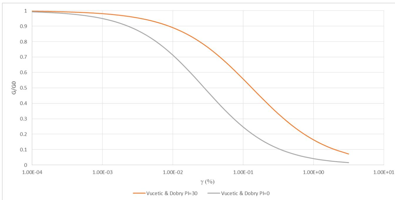
**Fig. 7 – Grafico delle curve di interpolazione di G/G<sub>0</sub>**
