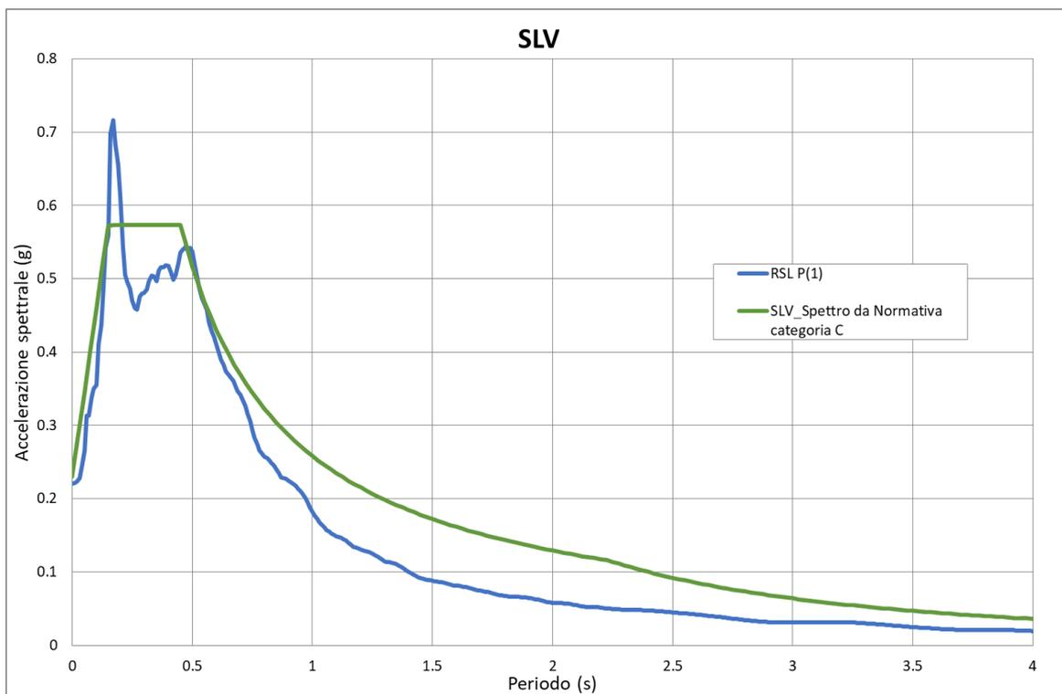
**Fig. 13 - Confronto tra lo spettro medio in output in accelerazione per il sito e lo spettro di riferimento da normativa**
