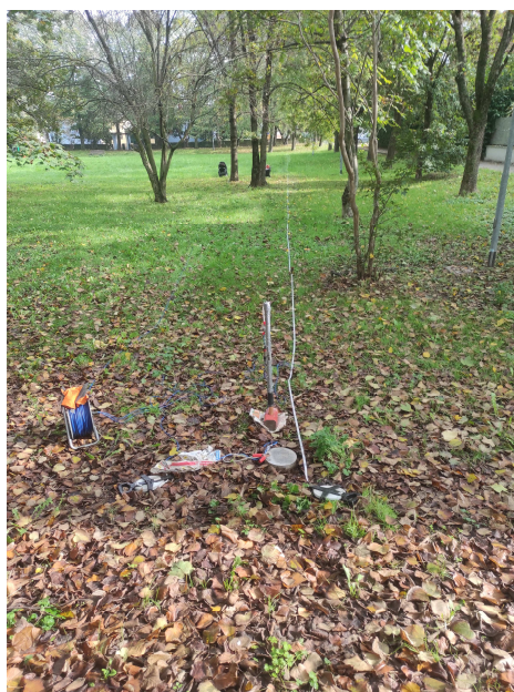
Figura 2/2. Stendimento sismico nel centro capoluogo di San Cesario sul Panaro (parco pubblico di via A. De Gasperi) – Punto di vista dal lato del geofono n. 1 (vista da ovest).
