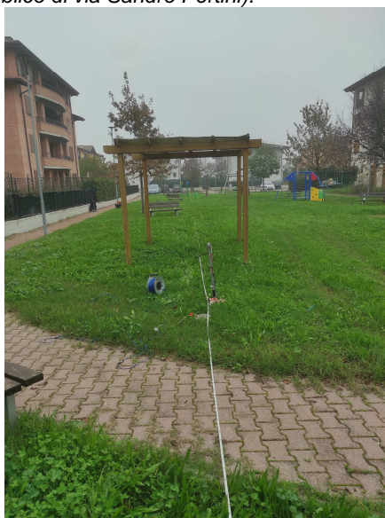
Figura 1/2. Stendimento sismico attivo nella frazione di Altolà di San Cesario sul Panaro (parco pubblico di via Sandro Pertini) – Punto di vista dal lato del geofono n. 1 (vista da ovest).
