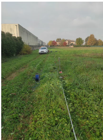
Figura 5/2. Stendimento sismico attivo di via del commercio (località La Graziosa) – Punto di vista dal lato del geofono n. 1 (vista da est).
