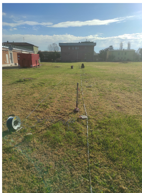
Figura 6/2. Stendimento sismico attivo di Sant'Ambrogio – Punto di vista dal lato del geofono n. 1 (vista da ovest).
