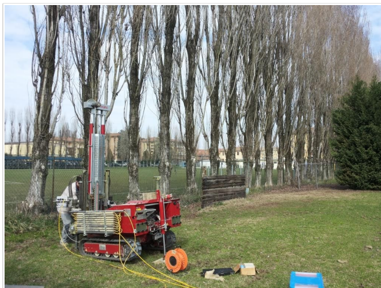
Foto 4.2 – Prova CPTU eseguita nel Capoluogo (Campo Sportivo comunale) con associata una registrazione sismica HVSR
