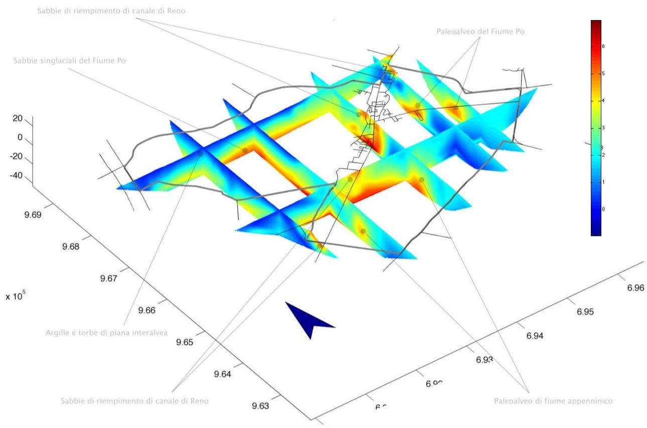
Figura 6-2 - Esempio di restituzione del modello tridimensionale mediante diagramma a graticcio, ritagliato sull'area comunale. I colori indicano le diverse classi granulometriche (argille = 2, sabbie = 6).
