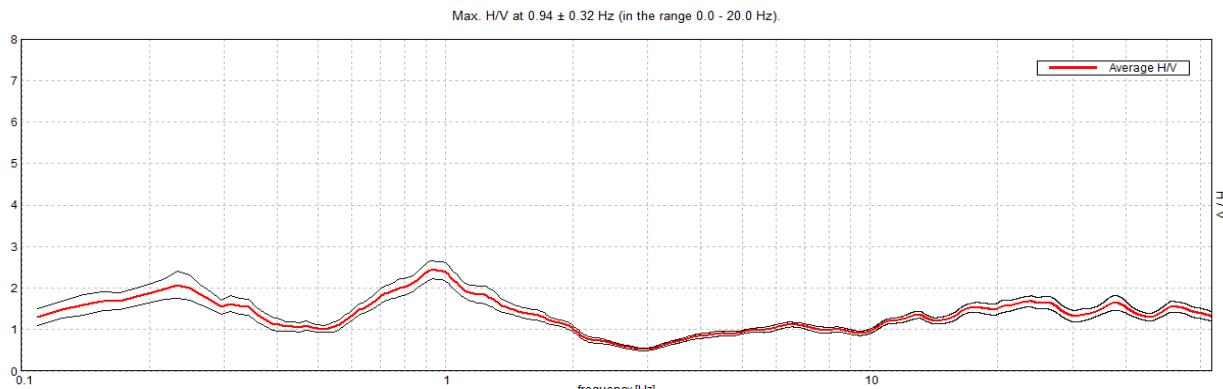
Figura 6-1 - Curva HVSR di una delle due misure di rumore ambientale realizzate in località Santa Teresa (prova 038016P346HVSR346) allo scopo di evidenziare eventuali picchi a bassa frequenza. Si nota che oltre al picco a 0,94 Hz se ne distingue bene un secondo a circa 0,25 Hz.
