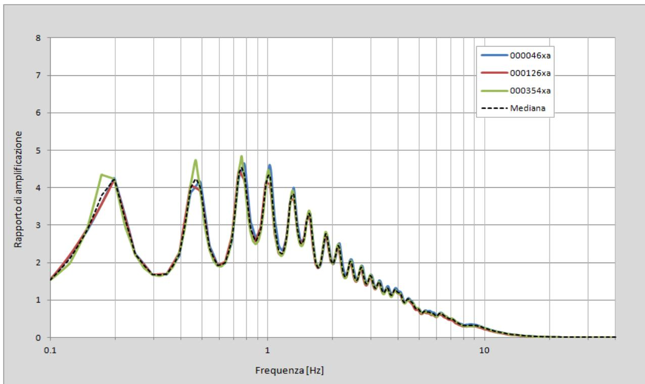
Figura 7-4 - Funzione di trasferimento (rapporto di amplificazione tra lo spettro del moto in superficie ed al bedrock) per i 3 terremoti di Figura 7-1 e per la mediana.
