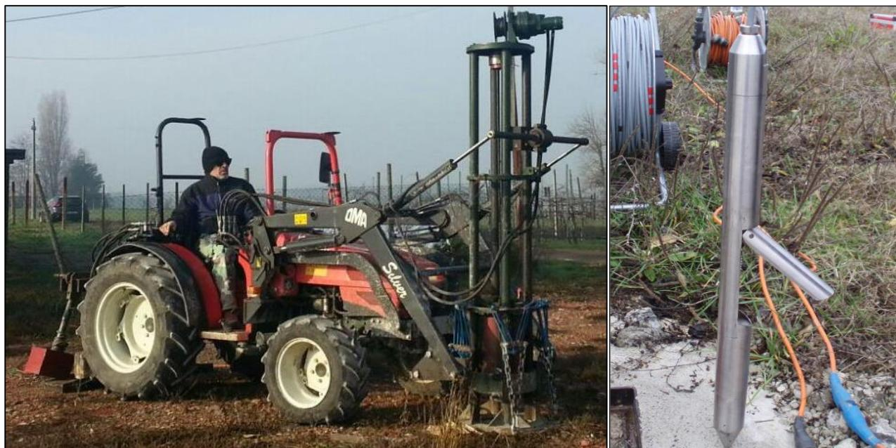
Figura 4-1 - A sinistra, macchina operatrice con funzione di sorgente delle onde sismiche. A destra, apparato di ricezione dei segnali costituito da sonda calettata contenente geofoni monoassiali da 10 Hz.
