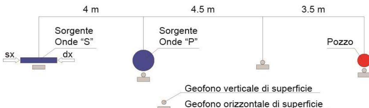
Figura 4-2 - Configurazione planimetrica schematica delle sorgenti e dei ricevitori utilizzati per l'indagine in foro di tipo down-hole.
