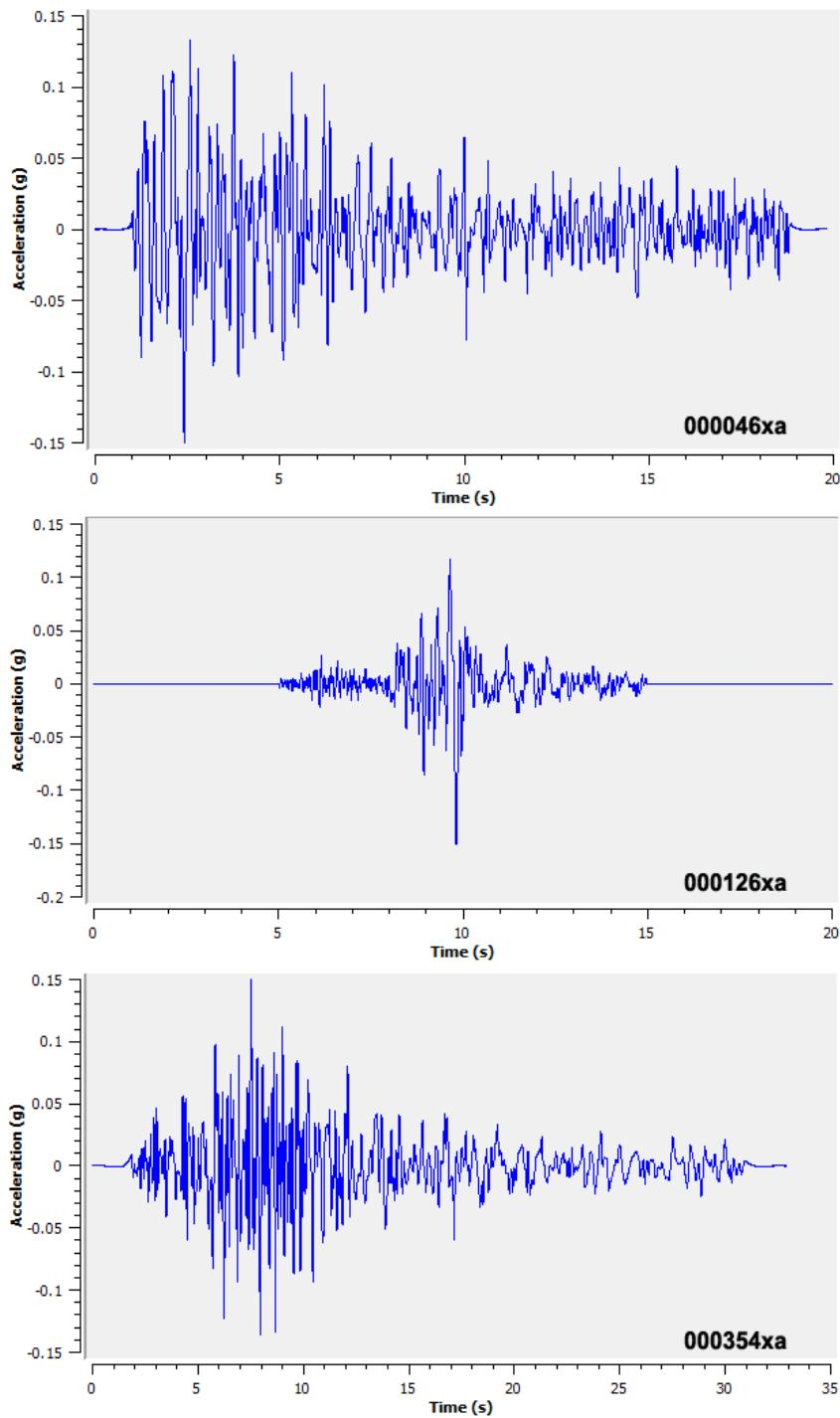
**Figura 7-2** - Plot eseguito con il software STRATA (Rathje e Kottke, 2013) dei segnali di riferimento forniti dalla Regione Emilia-Romagna in allegato alla D.G.R. 2193 del 2015, scalati per una  $a_{ref}$  pari a 0,15 e utilizzati come input per le simulazioni numeriche della risposta sismica locale.
