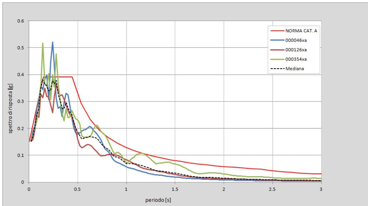
Figura 7-3 - Spettri di risposta al bedrock per i tre accelerogrammi e il loro spettro mediano, messi a confronto con lo spettro per la categoria A secondo le NTC2008.
