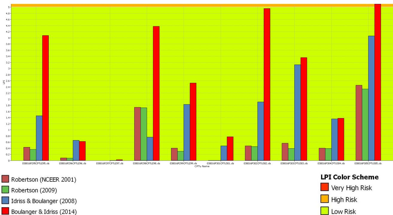
Figura 7-7 - Confronto tra diversi metodi di letteratura per la stima del potenziale di liquefazione, applicati allo stesso set di prove penetrometriche CPTU.
