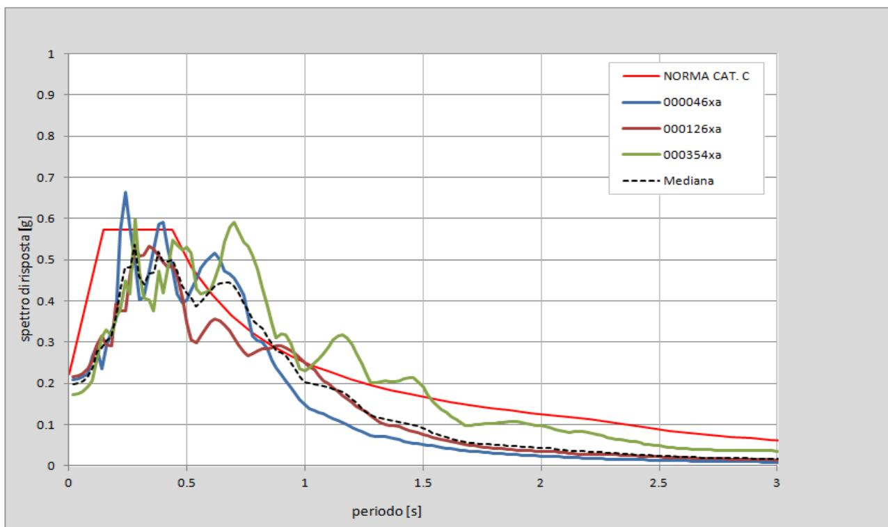
Figura 7-5 - Spettri di risposta in superficie per i tre accelerogrammi e il loro spettro mediano, messi a confronto con lo spettro per la categoria C secondo le NTC2008.
